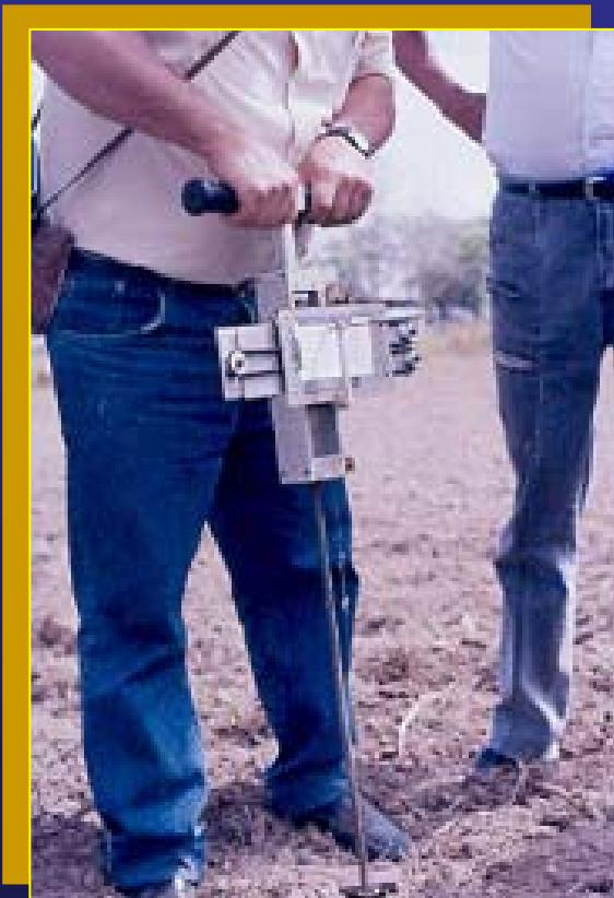
Penetrógrafo de punta cónica
