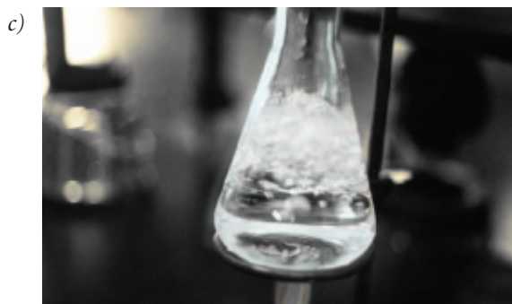
FIGURA I.2. El fenómeno tan frecuente de “hacer hervir el agua”, visto con detenimiento, muestra todos los procesos que suceden: a) las turbulencias por el calentamiento, b) el desprendimiento de los gases disueltos y, finalmente, c) la ebullición.
