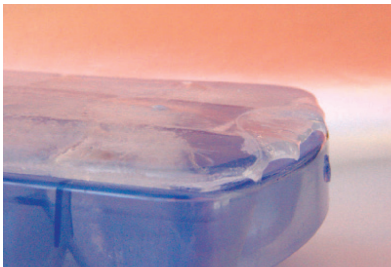
FIGURA I.3. Cuando el agua líquida se solidifica, aumenta su volumen debido a la manera como se conglomeran las moléculas. Esto se puede notar en una hielera.
