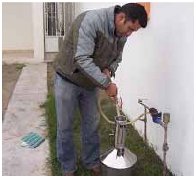
Figura 1.7 Prueba en campo de exactitud de micromedidores
