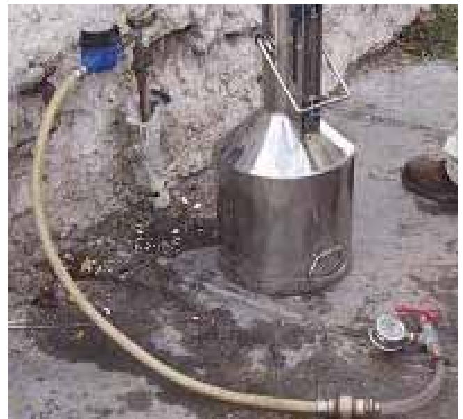
Figura 1.5 Equipo utilizado en pruebas de exactitud de micromedidores
