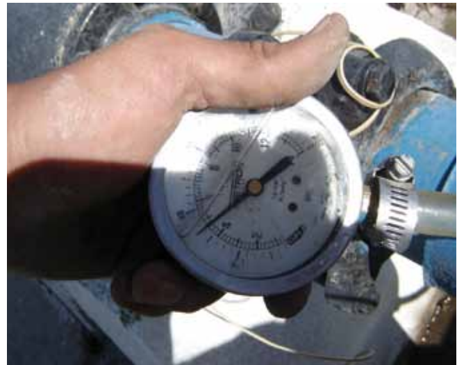
Figura 1.18 Medición de presión con manómetro tipo Bourdon calibrado
