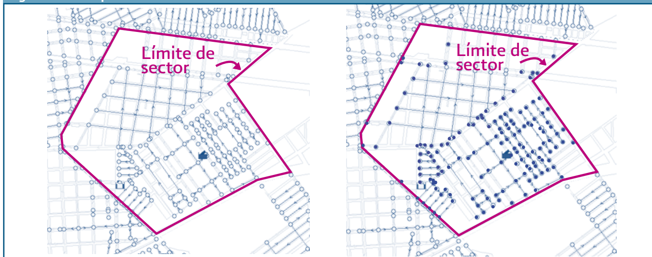
Figura 3.13 Comprobación de aislamiento de sector
