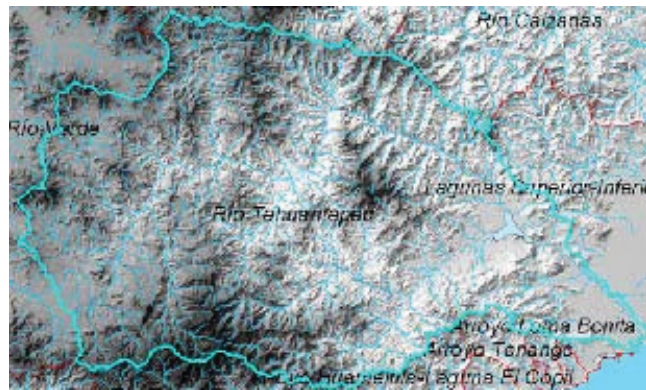
Sobreposición de red hidrográfica al modelo digital del terreno para verificar parteaguas
