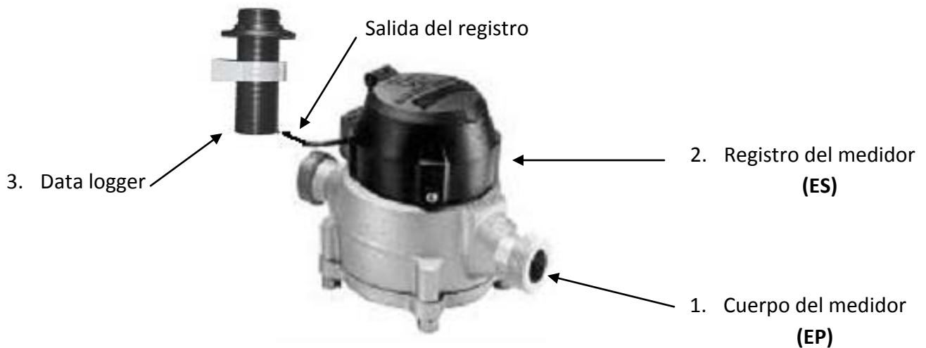
Figura 1. Partes de un medidor volumétrico. FUENTE: Badger Meter.
