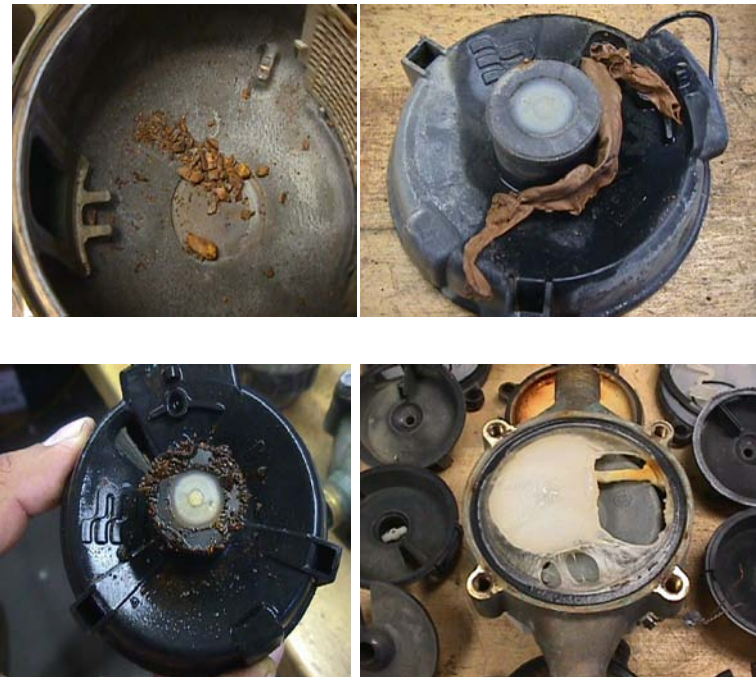
Figura 33. Incrustaciones en la cámara del medidor.
