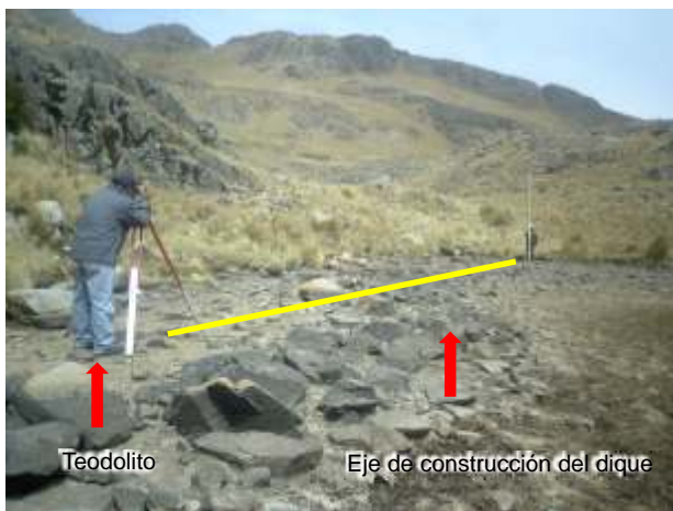
Levantamiento topográfico del área de una microrrepresa.
