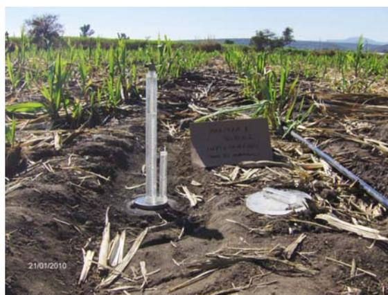
Foto 1. Prueba de infiltración en parcela seleccionada
