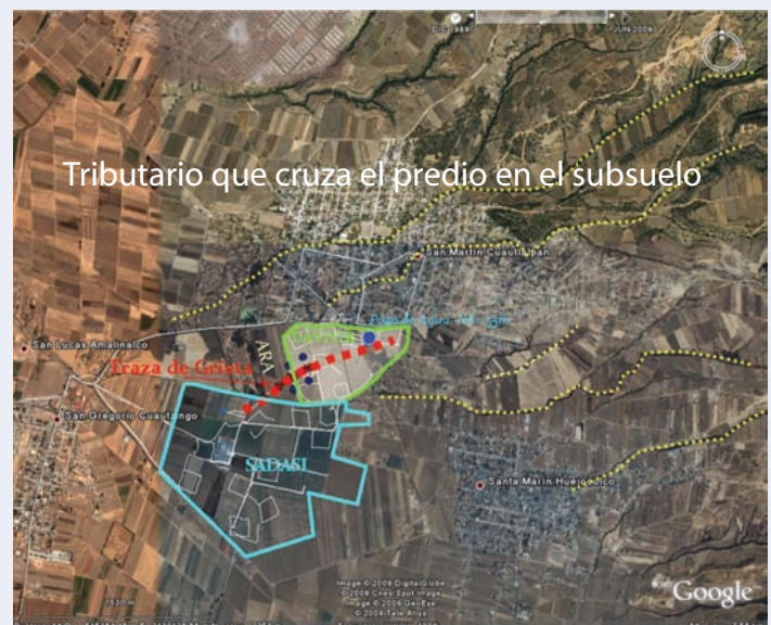
Se advierte el área de estudio, localizada al Sur de la población de San Martín Cuautlalpan, Mpio. de Chalco. Resalta en la imagen la red de escurrimientos superficiales del área, en sentido ENE-WSW y con rumbo semejante la traza de la grieta.
