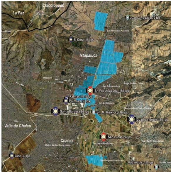
MAPA 3.5. UNIDADES DE RIEGO CON AGUAS SUBTERRÁNEAS EN RELACIÓN CON PTAR EXISTENTES Y FALTANTES
