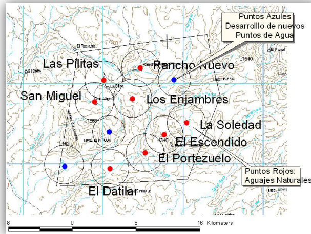
Figura 8.16. Ejemplo del uso de SIG para la ubicación óptima de fuentes de agua para abrevadero.
