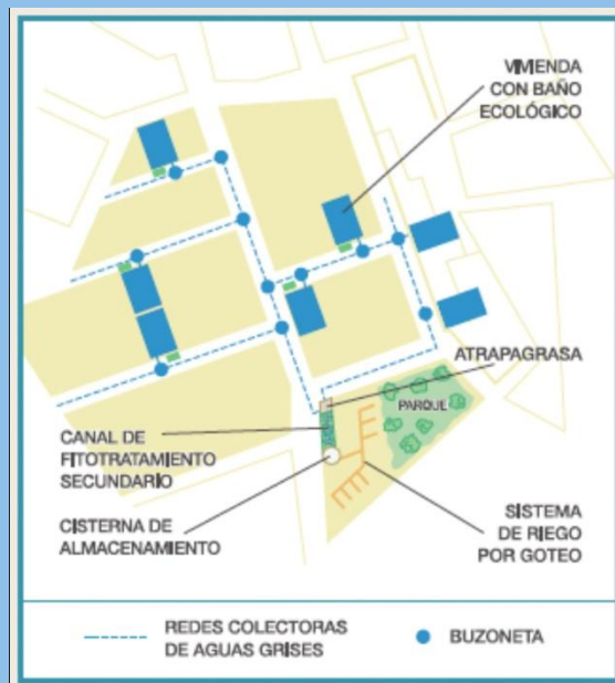
Figura 11. Esquema de sistemas de recolección y tratamiento con biofiltros de efluentes, para riego de parque comunitario.
