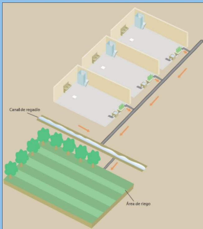
Figura 10. Sub-sistema vecinal de tratamiento de efluentes.
