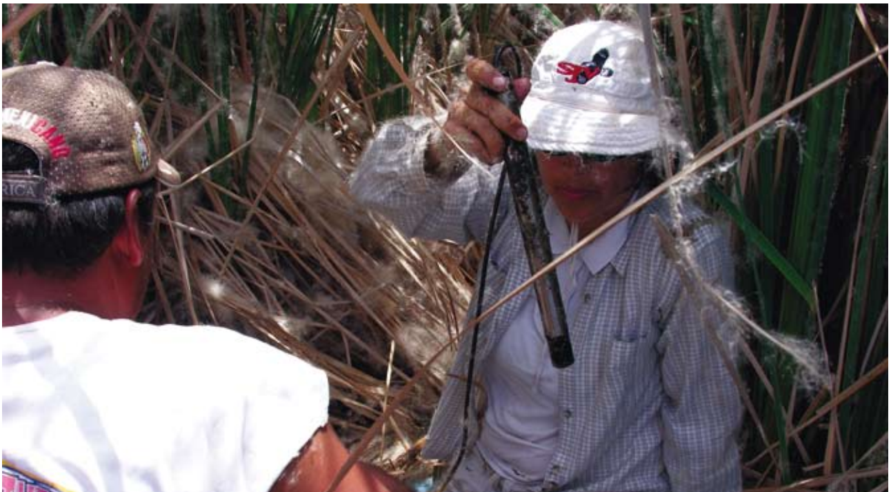
Transfiriendo datos de los sensores de conductividad instalados en la Ciénega
