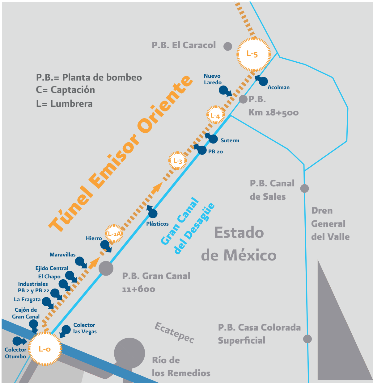
Figura 27. Ubicación de las obras de captación al TEO.
