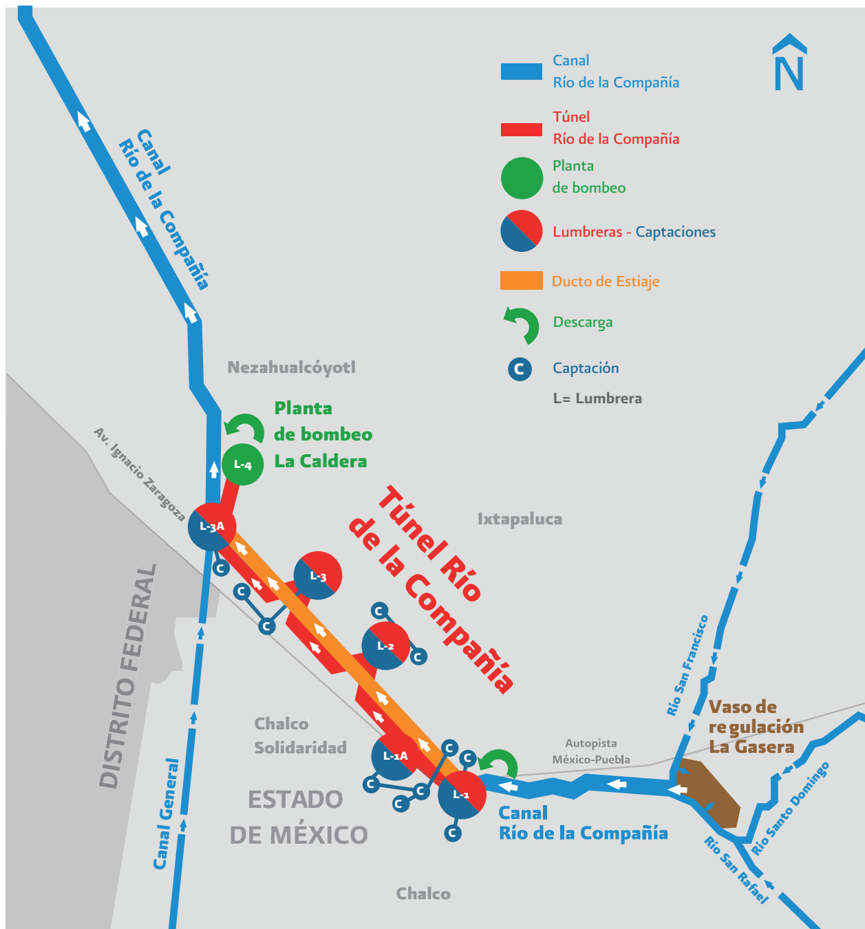
Figura 12. Sistema de obras de drenaje del oriente-sur del Valle de México.
