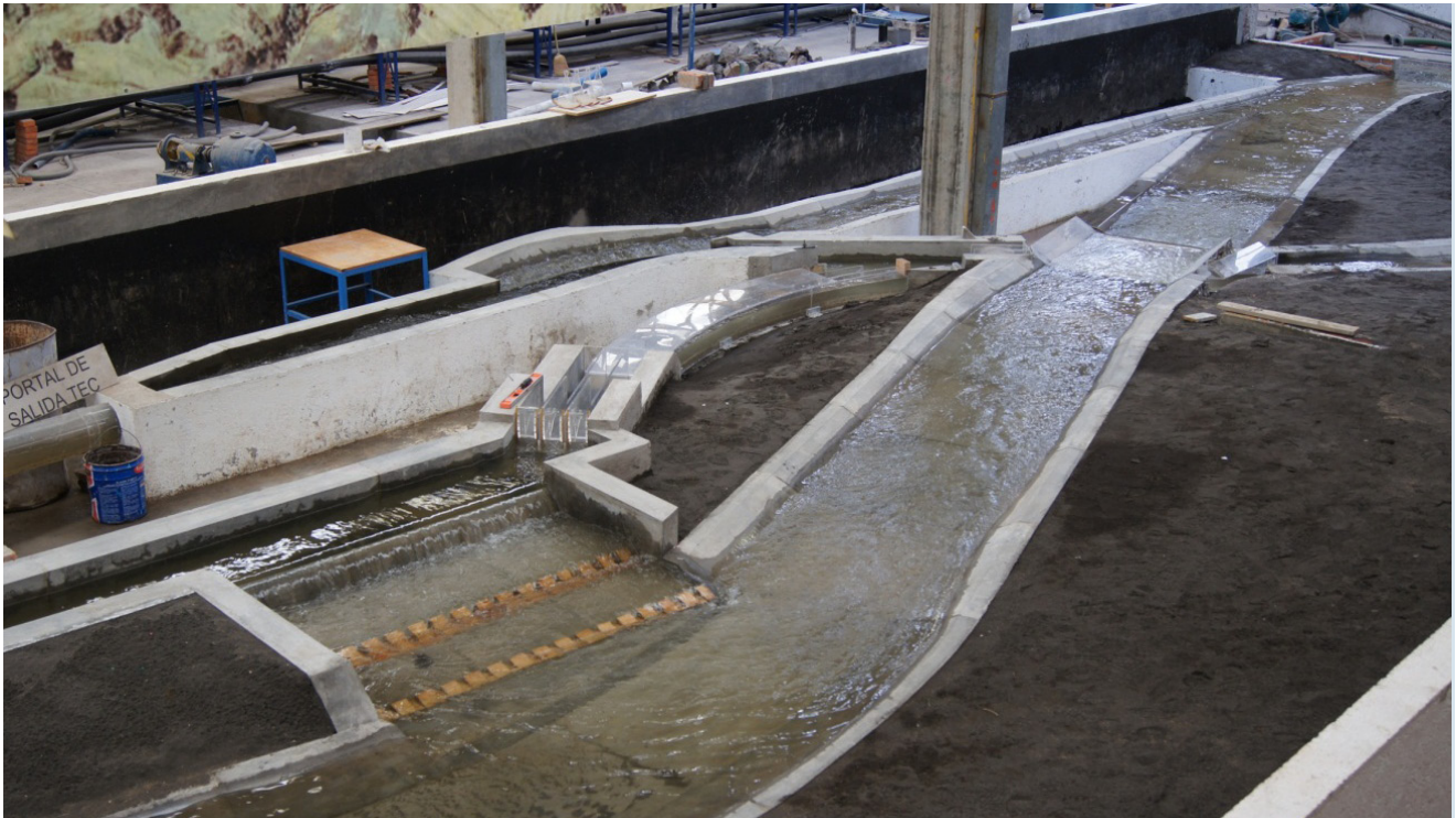
Modelo físico para el manejo de caudales a la salida del TEO.
