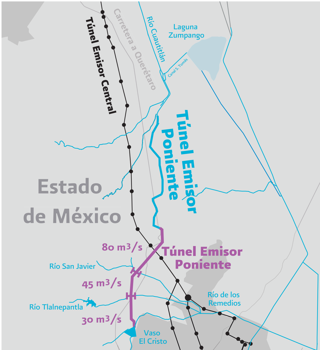
Figura 8. Obras de drenaje asociadas al Túnel Emisor Poniente; capacidades del túnel.
