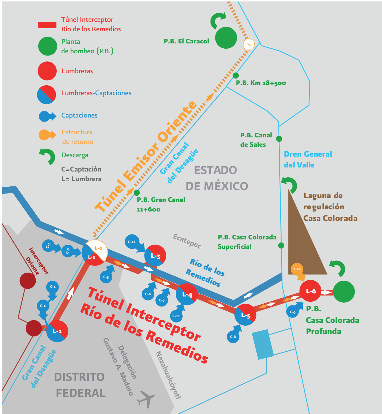
Figura 11. Sistema de obras de drenaje del oriente y centro del Valle de México.
