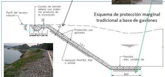
CORTE ILUSTRATIVO DE PROTECCION MARGINAL DE POR VIDA A BASE DE ROCAS VOLCÁNICAS VACIADA A GRANEL. EN SAN RAFAEL, HASTA EDIFICIOS ESTA CARGANDO, PIDAN DE ESTAS, NO BORDOS
