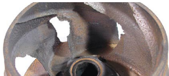
Corrosión por erosión de un impulsor de hierro fundido
