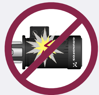
Fig. 1.4.5: En motores con seguridad ampliada EExe, no pueden producirse chispas. La clasificación de temperatura cubre tanto las superficies internas como externas. Consulte el texto en PDF
