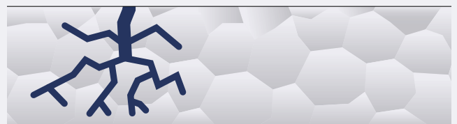
Fig. 1.6.10: Grietas de corrosión por tensión Consulte el texto en PDF
