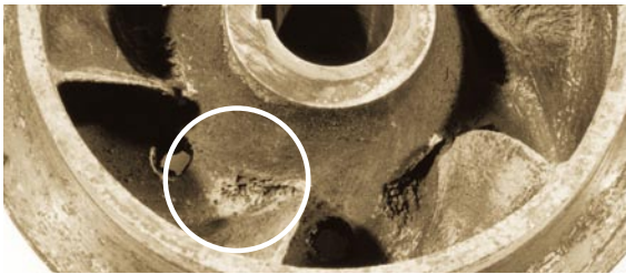
Corrosión por cavitación de un impulsor de bronce
