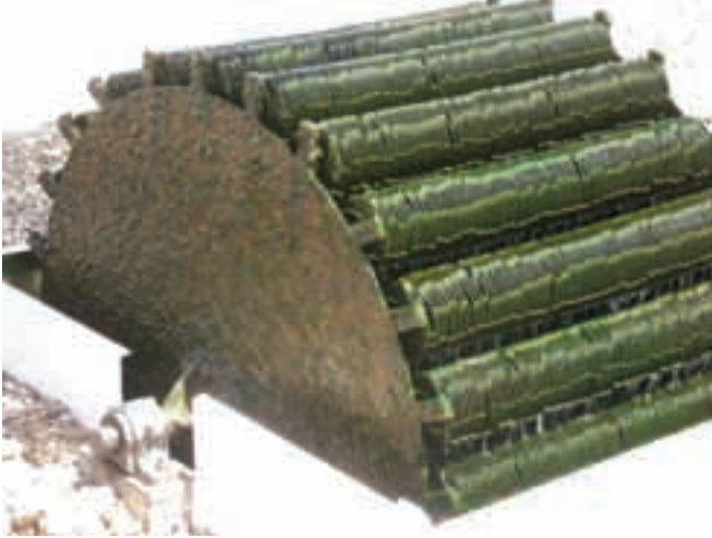
Foto 5.20. Detalle de Contactor Biológico Rotativo.
