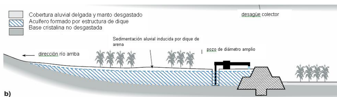
Figura 10.6 Sección transversal de la estructura del dique de arena (de Foster y Tuinhof, 2004)
