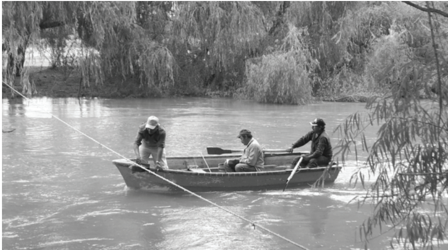
Figura 38. Aforo en el río Nazas utilizando una cuerda tipo “retenida”, para evitar sesgos en la sección transversal y en lancha.
