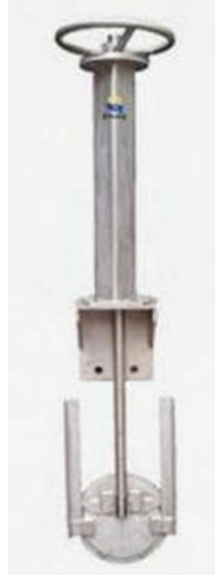
Figura 83. Compuerta tipo Miller para toma-granja. Parte inferior: compuerta circular que obtura el tubo que comunica al canal con la regadera parcelaria; es izada por un vástago cilíndrico que es elevado por el volante de la parte superior, que tiene un candado para trabar la compuerta en la posición deseada.
