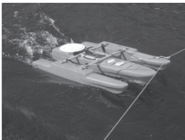
Figura 49. Dos diferentes modelos de medidores acústicos Doppler montados en soportes flotantes, comúnmente llamados “barquito” o “catamarán”.
