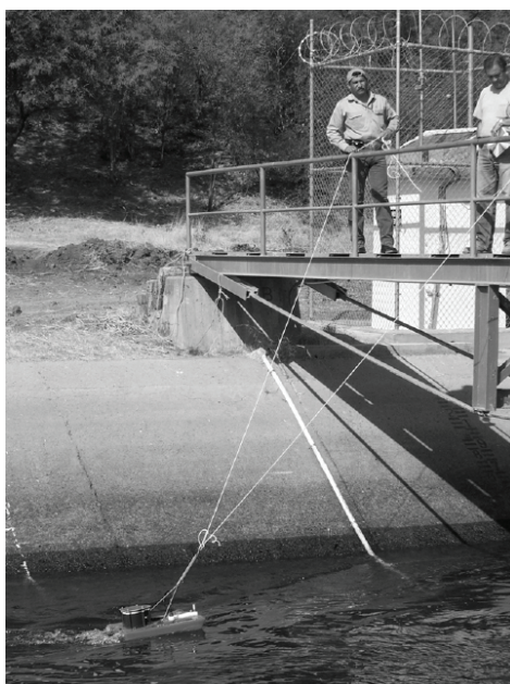
Figura 48. Medidor acústico Doppler montado en una embarcación pequeña, usando puente rígido de metal.
