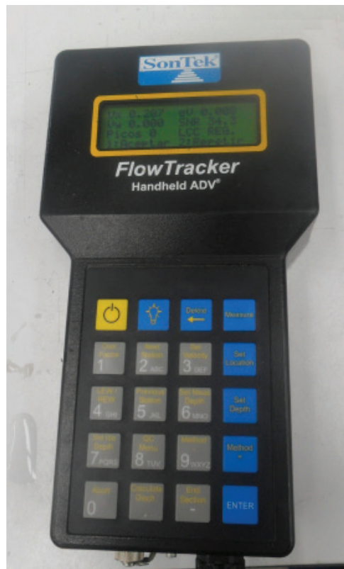
Figura 53. ADV marca Sontek, modelo Flowtracker. Cortesía del M.I. Arturo López Zúñiga.
