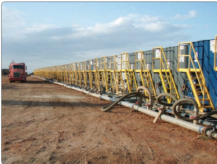
Tanques de agua alineados en preparación para fractura hidráulica.
