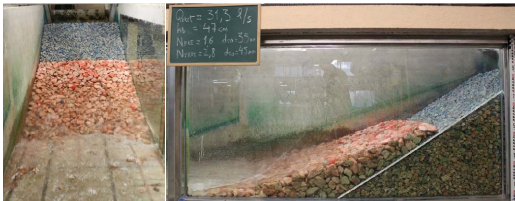
Foto 32. Alzado y vista lateral del caso de verificación de la protección con caudal de 23,7 l/s/m. Campaña de verificación. Caudal de diseño de 25 l/s/m.
