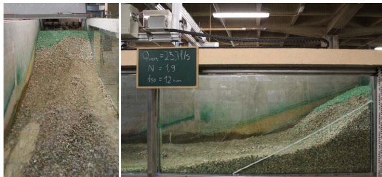
Foto 27. Alzado y vista lateral de la rotura de la presa sin protección con escalón de caudal 17,9 l/s/m. Campaña de verificación. Material M1 ( D_{50} = 12 mm)
