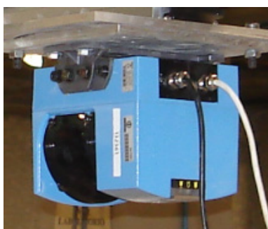
Foto 13. Imagen del perfilómetro láser montado sobre la placa de sujeción al carro robotizado.
