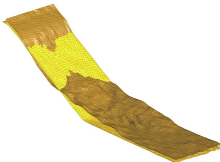
Figura 97. Vista de la erosión producida sobre el talud a través de la comparación entre la superficie paralela al talud original a 2 cm de profundidad (color amarillo) y la superficie rota (color marrón).
