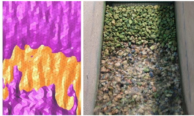
Figura 101. Izquierda: Vista en planta del modelo digital del terreno, representando la erosión en un talud 2,00 correspondiente a un mecanismo de rotura mixto entre la erosión y el deslizamiento.
