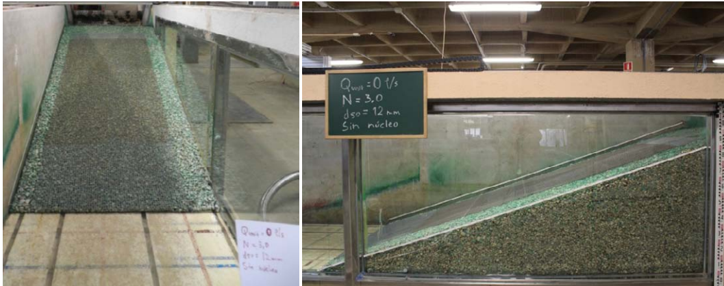
Foto 22. Ejemplo de la disposición de ensayo de la fase de calibración de la ley de resistencia.
