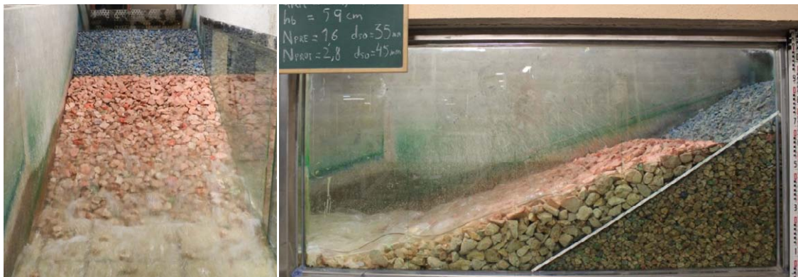
Foto 34. Alzado y vista lateral del caso de verificación de la protección con caudal de 34,6 l/s/m. Campaña de verificación. Caudal de diseño de 35 l/s/m.
