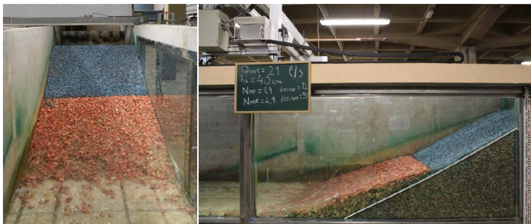
Foto 29. Alzado y vista lateral del caso de verificación de la protección con caudal de 15,9 l/s/m. Campaña de verificación. Caudal de diseño de 16 l/s/m.
