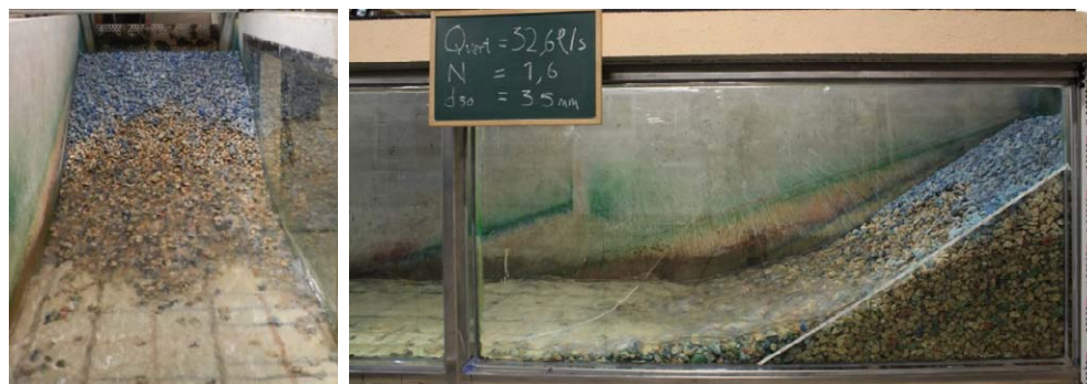
Foto 30. Alzado y vista lateral de de la rotura de la presa sin protección con escalón de caudal 24,7 l/s/m. Campaña de verificación. Material M2 ( D_{50} = 35 mm)
