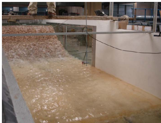
Foto 10. Sonda de ultrasonidos situada aguas abajo del modelo
