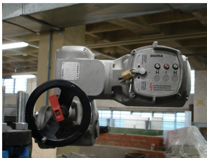
Foto 7. Electroválvula con actuador automático programable.
