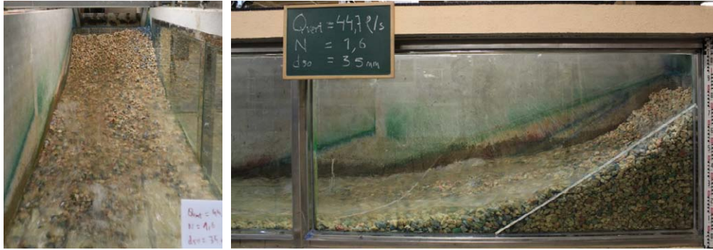
Foto 31. Alzado y vista lateral de la rotura de la presa sin protección con escalón de caudal 33,8 l/s/m. Campaña de verificación. Material M2 ( D_{50} = 35 mm)
