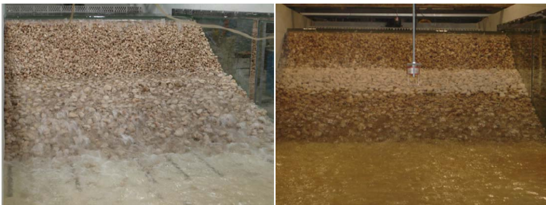
Foto 35. Vista del comportamiento estable del material de protección E_b , con talud 3,0 para alturas de repié de 0,40·H (izquierda) y 0,60·H (derecha).
