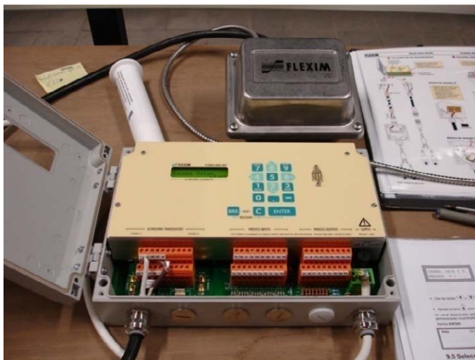
Foto 8. Caudalímetro por ultrasonidos FLUXUS ADM 7407
