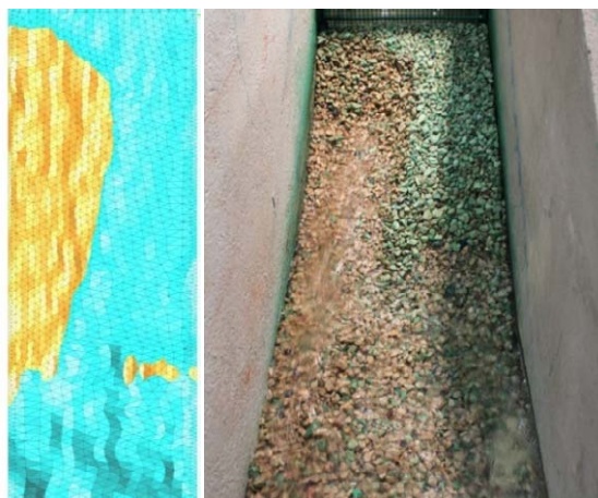
Figura 99. Izquierda, imagen en planta del modelo digital de la erosión en un talud 2,60 con predominio del mecanismo de arrastre. Derecha, fotografía correspondiente a dicho caso tomada en el canal de ensayo con ancho de 60 cm.
