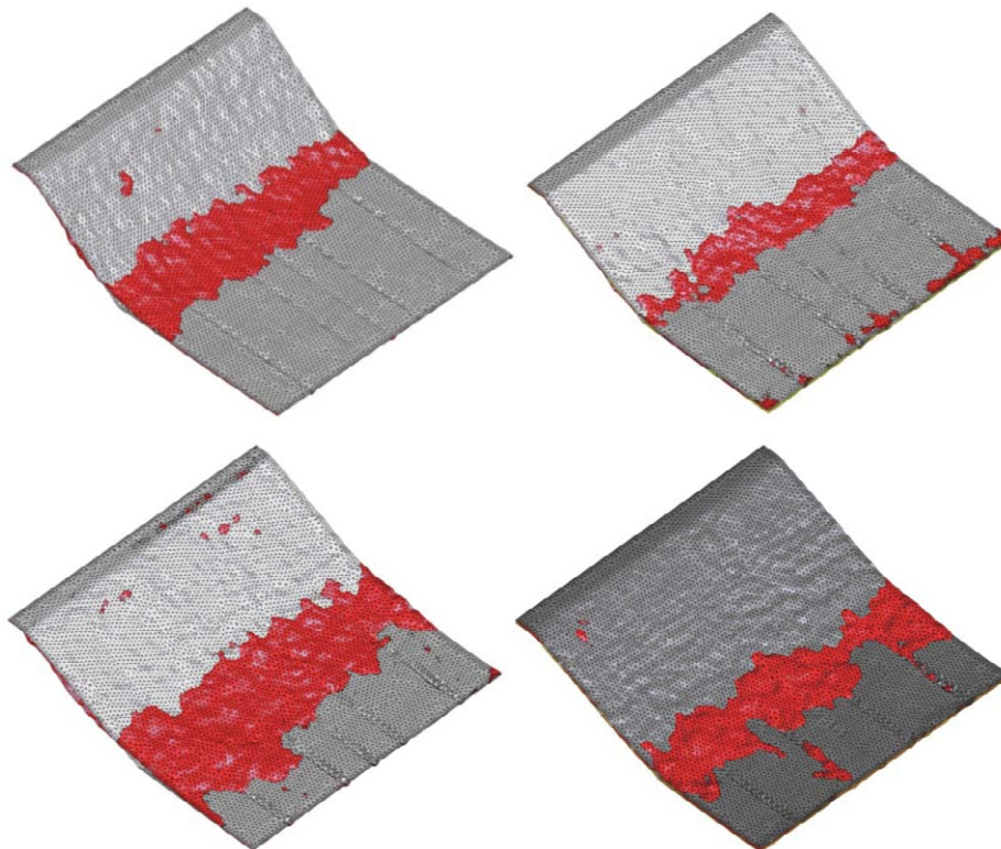
Figura 177. Vista isométrica del depósito de material deslizado para el caudal de rotura correspondiente a los taludes 1,50; 1,75; 2,00 y 2,20 (de izquierda a derecha y de arriba abajo) con el material M1 ( D_{50} = 12,6 mm).
