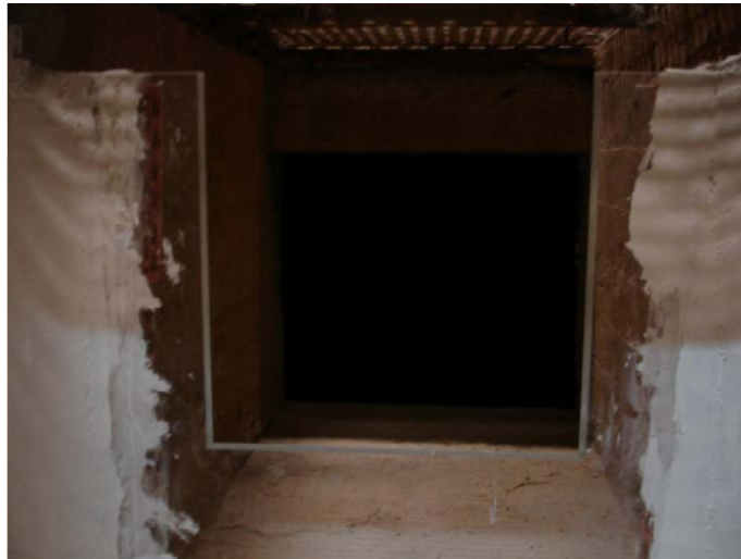
Foto 9. Vertedero rectangular en pared delgada
