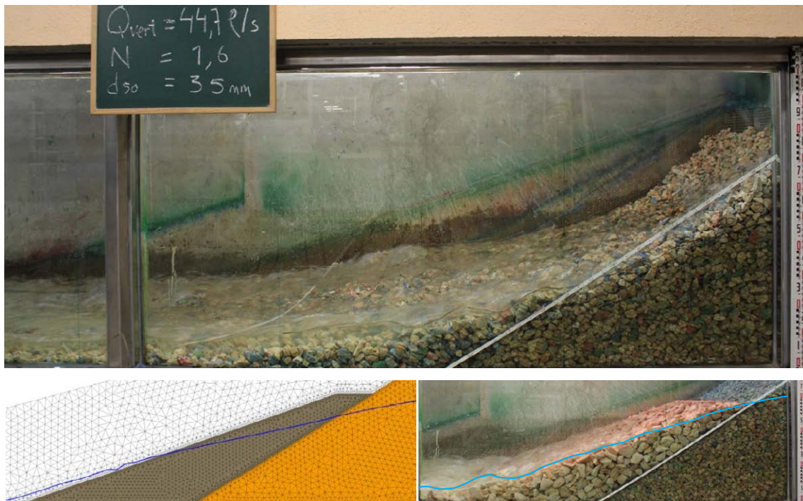
Figura 257. Montaje correspondiente a los ensayos realizados correspondientes al caso 35_45_35. Foto superior: presa desprotegida con caudal unitario de 33,8 l/s/m. Figura inferior: modelo de filtración correspondiente al caudal de diseño ( q_d=35 l/s/m). Foto inferior: protección con caudal de percolación q_s=34,6 l/s/m.
