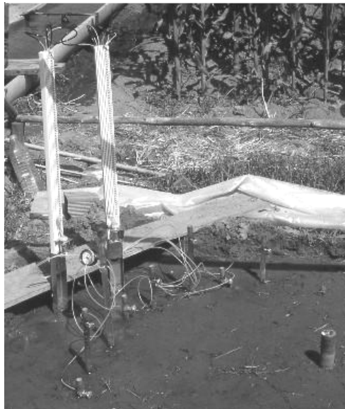
Figura 3.11. Monolito de suelo equipado con tensiómetros de mercurio y tubo de acceso para la sonda de neutrones al inicio del período de drenaje para la determinación de las curvas de retención y de conductividad hidráulica de un suelo regado.
