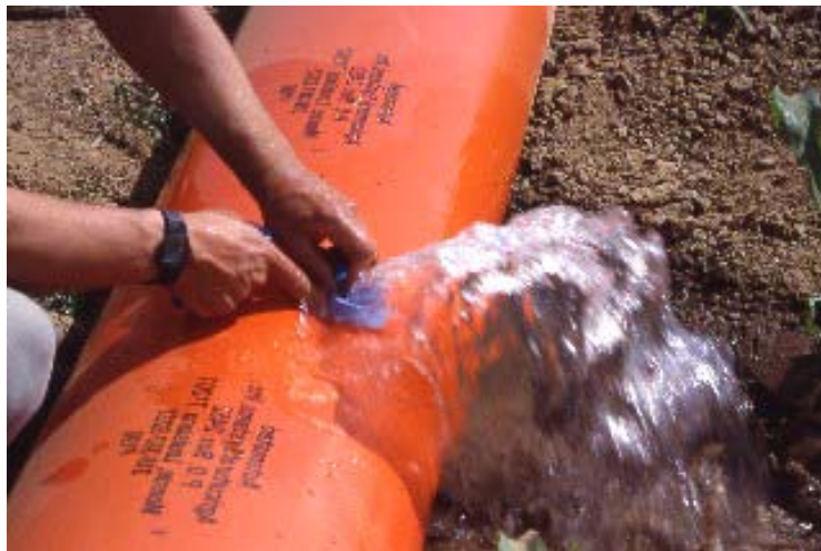
Figura 5.24. Tubo flexible con compuertillas: colocación de la compuertilla.
