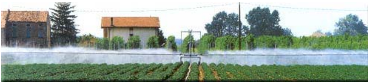
Figura 6.68. Ala sobre carro traccionada por un enrollador cuyo tubo es visible en el centro.
