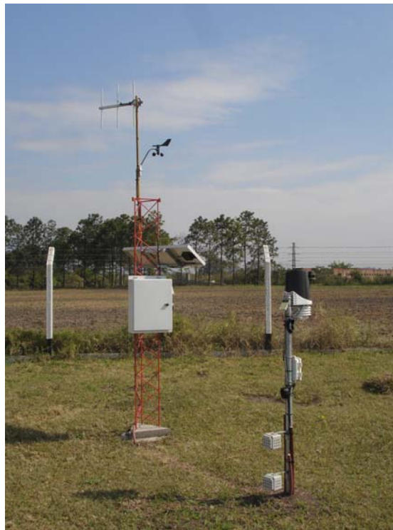
Figura 1.12. Estación agroclimática automatizada instalada en la Estación Experimental Agroindustrial Obispo Colombres, en Argentina, sobre una cubierta cespitosa en un entorno de regadío, con sensores de radiación neta y global, temperatura y humedad relativa del aire, velocidad y dirección del viento y precipitación.
