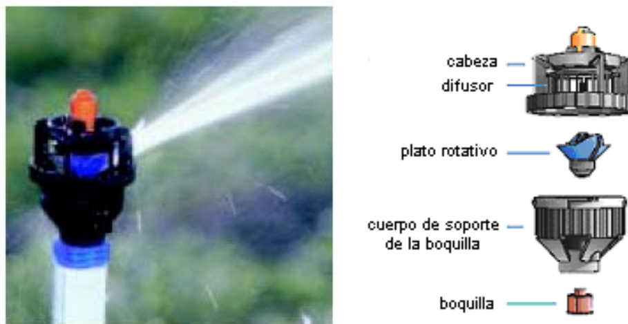
Figura 6.11. Aspersor “rotator” de plato rotativo. Nelson (2003).
