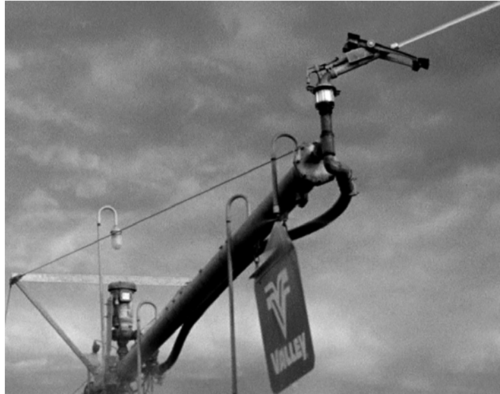
Figura 6.53. Cañón en el extremo del ramal pivotante, con bomba de sobrepresión.
