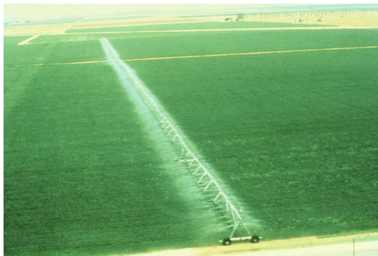
Figura 6.67. Lateral de avance frontal bien alineado, abastecido por un canal en el centro.
