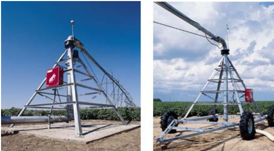
Figura 6.52. Ejemplos de centro pivote mostrando la tubería de alimentación, el tramo de la tubería vertical, con junta giratoria que abastece al lateral, y el cuadro de mando, para un sistema trasladable y otro fijo.
