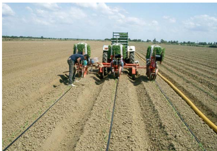
Figura 7.15. Colocación mecanizada de tubos de cámara doble. El tubo, flexible, está enrollado en carretes y, en riego subsuperficial, es regulable a la profundidad de colocación.
