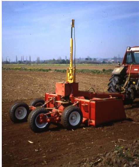
Figura 5.20. Nivelado de un cantero con láser.
