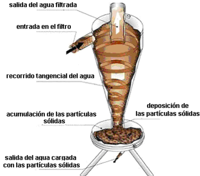
Figura 7.39. Filtro de vórtice o hidrociclón.
