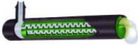
Figura 7.10. Gotero de largo recorrido, con laberinto, y de colocación exterior en la tubería.
