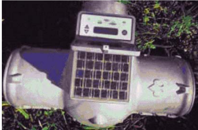
Figura 5.29. Válvula para el riego intermitente (“surge-flow”), a aplicar en riego de surcos, equipada con controlador electrónico y su alimentación con panel solar.
