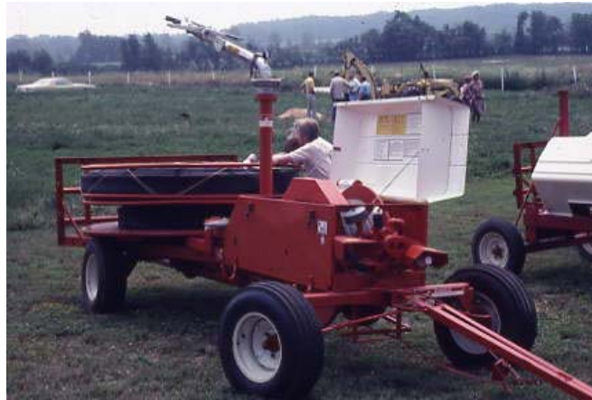
Figura 6.46. Cañón viajero con dispositivo para el transporte de la manguera y el cable de tracción enrollados en sus correspondientes tambores.
