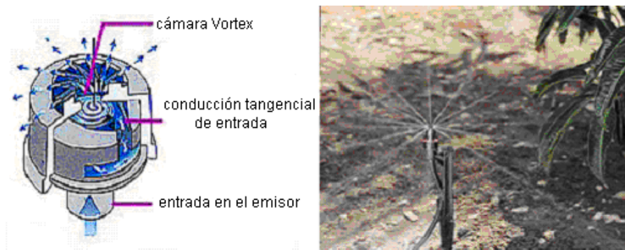
Figura 7.11. Microaspersor de vórtice y su montaje en derivación.
