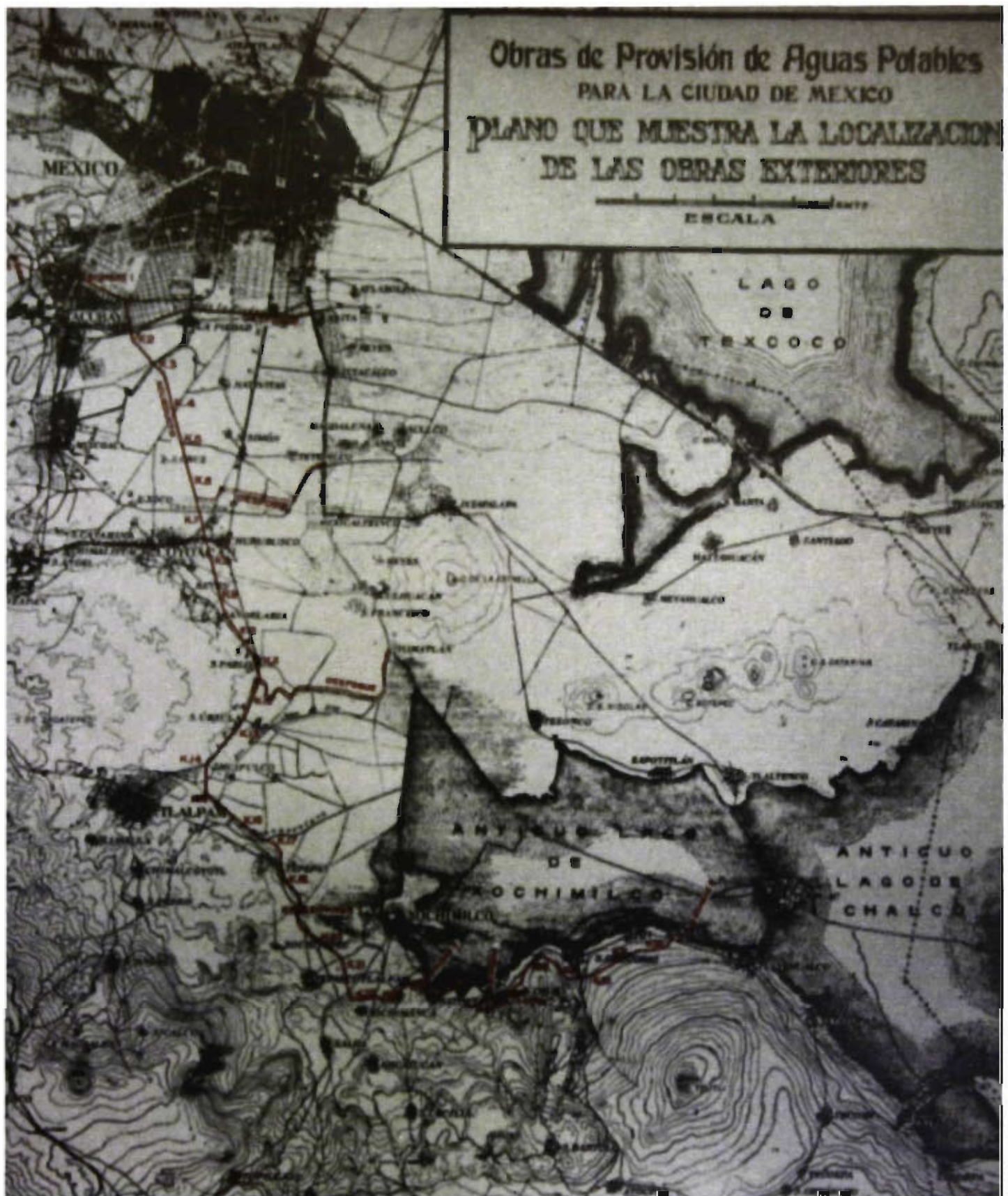
Plano del acueducto de Xochimilco construido durante los últimos años del porfiriato; por él se entubó el agua de los manantiales del sur, desde San Luis Tlaxialtemalco hasta la casa de Bombas en la colonia Condesa. Dicho acueducto aún está en funcionamiento.
