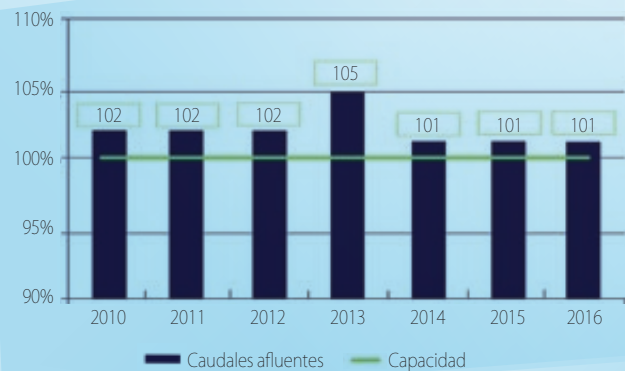
Gráfica 1. Planta depuradora de Gabal El Asfar. Caudales afluentes vs. capacidad
