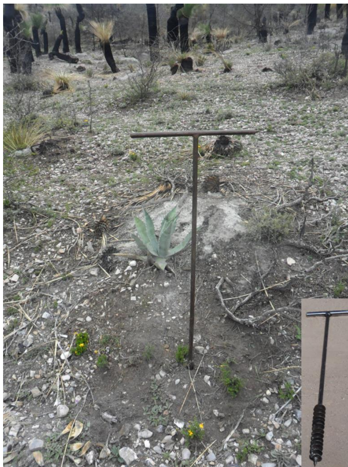
Figura 26. Barrena helicoidal para medir profundidad del suelo. Fotografía: UACH y CONAFOR (2012).
