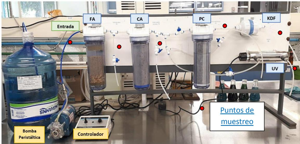
Figura 17. Sistema piloto para la potabilización del agua de lluvia captada en la AMC. Fuente: Elaboración propia.
