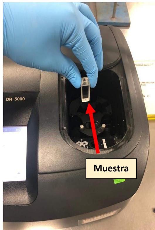
**Figura 9. Espectrofotómetro DR 5000 para la determinación de absorbancia  $UV_{254}$  y color en las muestras de agua. Fuente: Elaboración propia.**
