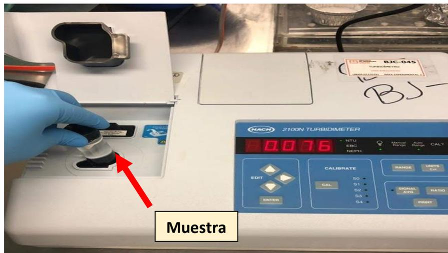
Figura 16. Turbidímetro HACH 2100N empleado en la determinación de turbiedad en las muestras de agua. Fuente: Elaboración propia.
