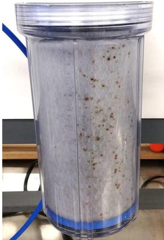
**Figura 20. Cartucho de CA saturado con sólidos no disueltos. Fuente: Elaboración propia.**
