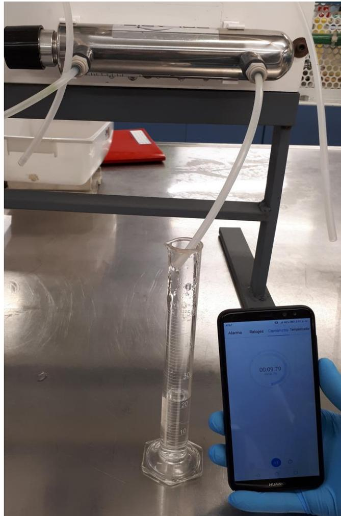
**Figura 18. Medición de flujo en la barrera UV del sistema de potabilización. Fuente: Elaboración propia.**
