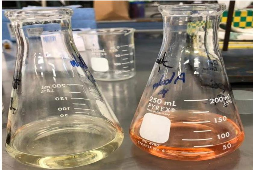
**Figura 10. Determinación de alcalinidad total por cambio de color de amarillo pajizo a rojo canela mediante titulación de  $H_2SO_4$  en las muestras de agua. Fuente: Elaboración propia.**
