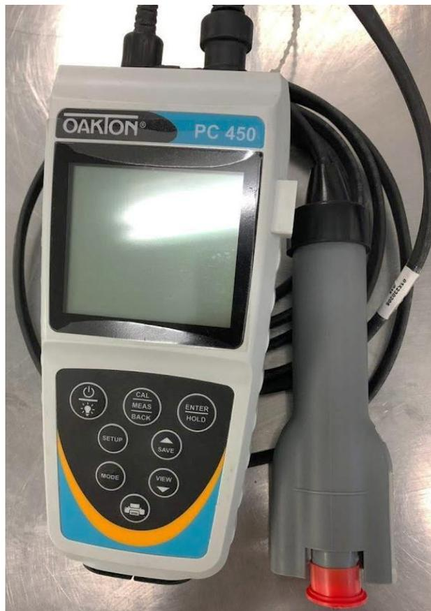
**Figura 13. Multiparámetro de la marca OAKTON empleado para la determinación de conductividad eléctrica, SDT y pH. Fuente: Elaboración propia.**
