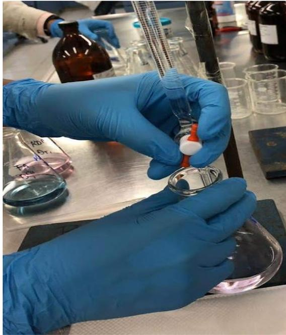
**Figura 14. Determinación de dureza total y dureza debida al ión calcio en las muestras de agua. Fuente: Elaboración propia.**
