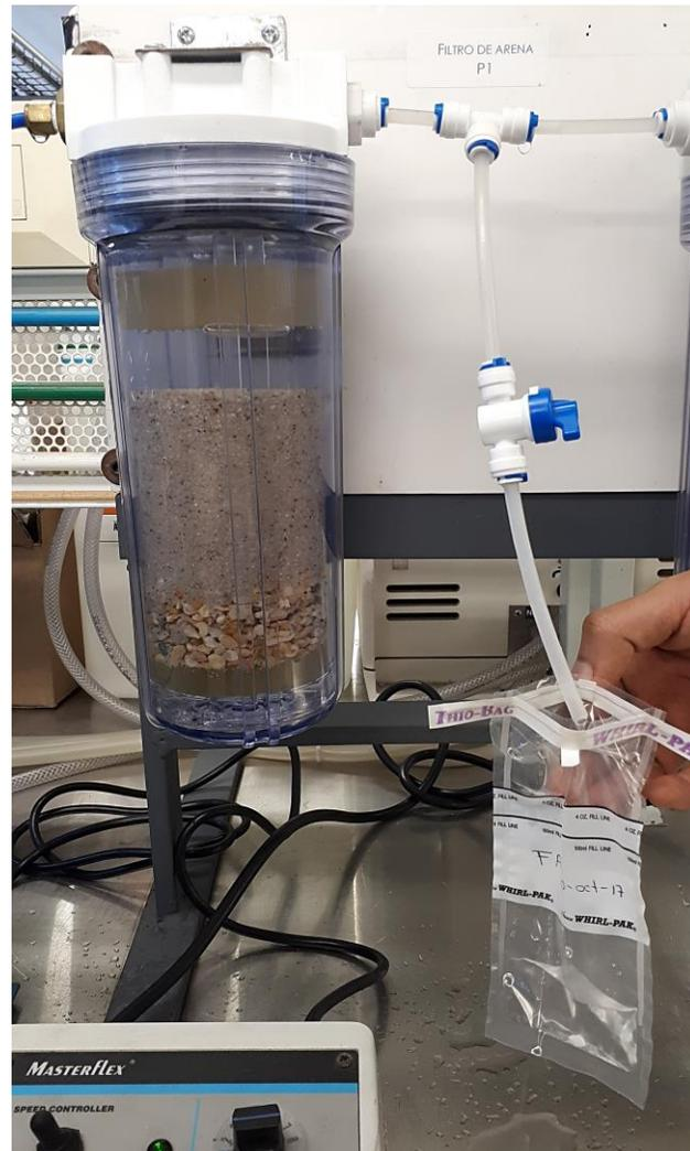
**Figura 19. Toma de muestra para la determinación de los parámetros coliformes totales y coliformes fecales. Fuente: Elaboración propia.**
