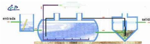
figura 1. Esquema del proceso general de un reactor de lodos activados
