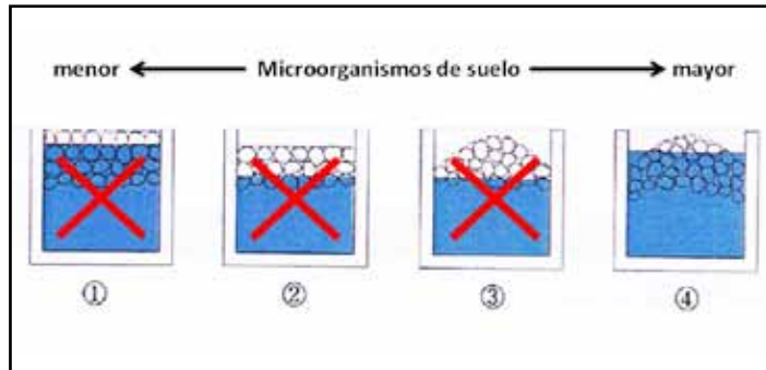
Figura No. 6 Relación entre la disposición del medio filtrante y sus microorganismos
