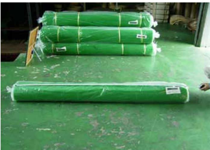
Fotografía No. 14 Malla de recubrimiento
