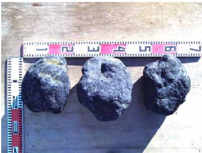
Fotografía No. 10 Material para el empaque de grava
