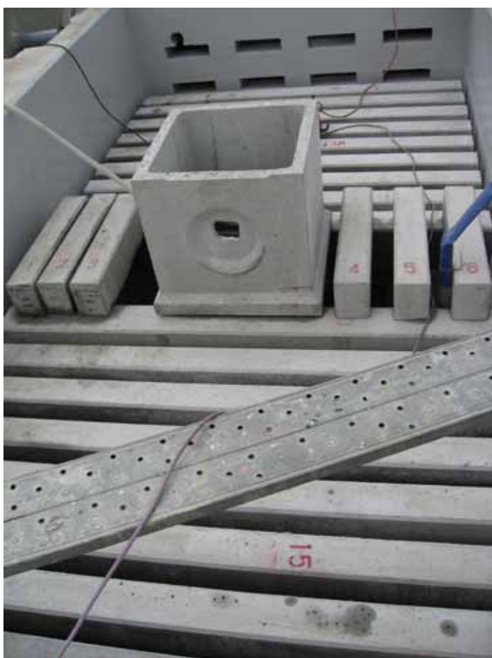
Fotografía No. 36 Arreglo de traves de soporte
