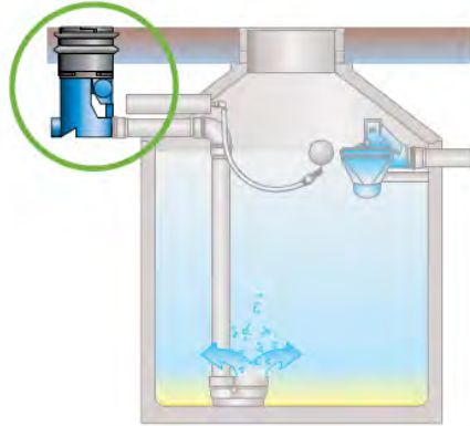
Figura IV.1.9.2 1er Nivel de limpieza (Fuente: 3P Technik)
