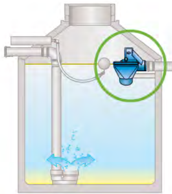
Figura IV.1.9.4 3er Nivel de limpieza (Fuente: 3P Technik)
