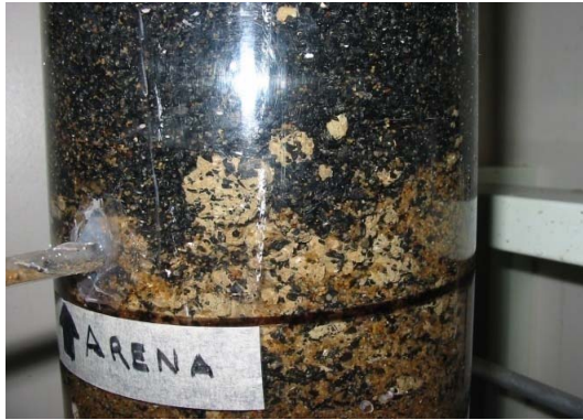
a) Bolas de lodos entre la arena y la antracita.
