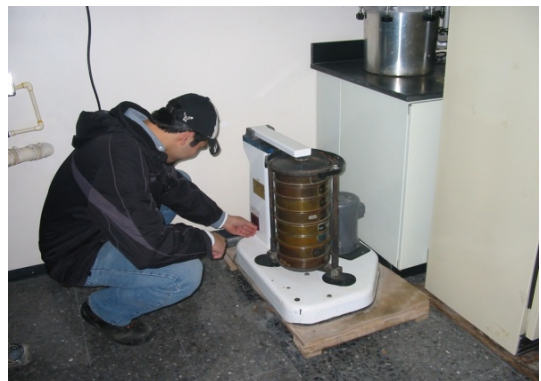
b) Tamizado, del material filtrante con equipo Ro-Tap.
