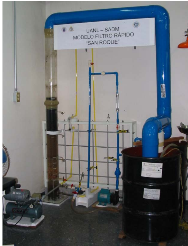
Figura No. 11. Fotografía del filtro piloto.
