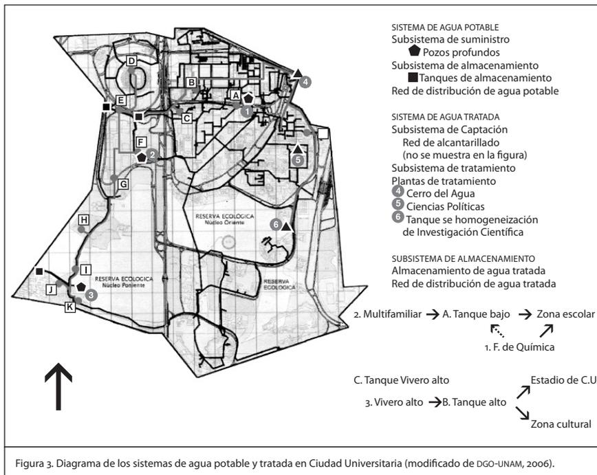
Figura 3. Diagrama de los sistemas de agua potable y tratada en Ciudad Universitaria (modificado de DGO-UNAM, 2006).
