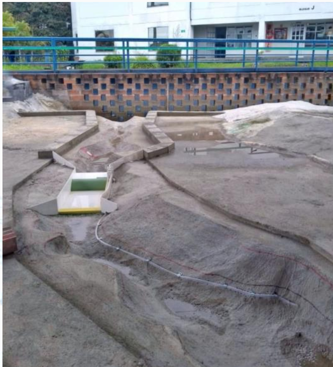
Fotografía 2. Modelo físico a escala reducida Río Pozo Fuente: Propia
