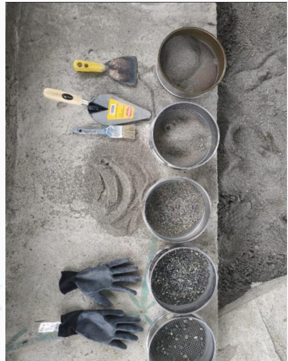
Fotografía 3. Tamizado y clasificación de los sedimentos Fuente: Propia
