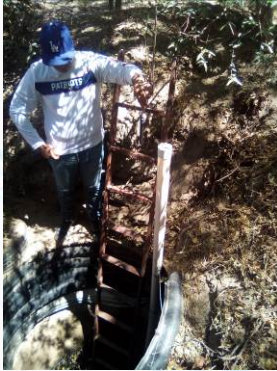
Fotos 5,6 y 7 Colocación de level logger dentro noria y de cárcava principal del polígono de 5Ha
