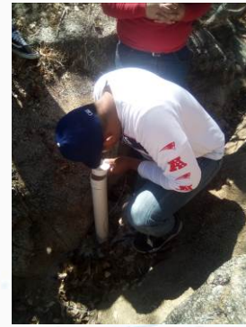
Fotos 5,6 y 7 Colocación de level logger dentro noria y de cárcava principal del polígono de 5Ha
