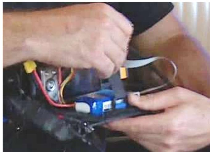
Figura E.7 Acomodo de la batería a la montura de cámara
