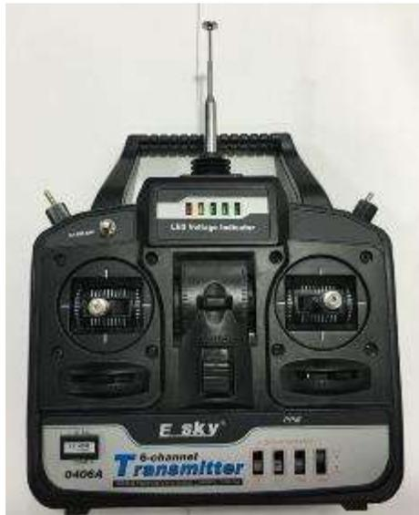
Figura B.11 Transmisor de radio de 6 canales
