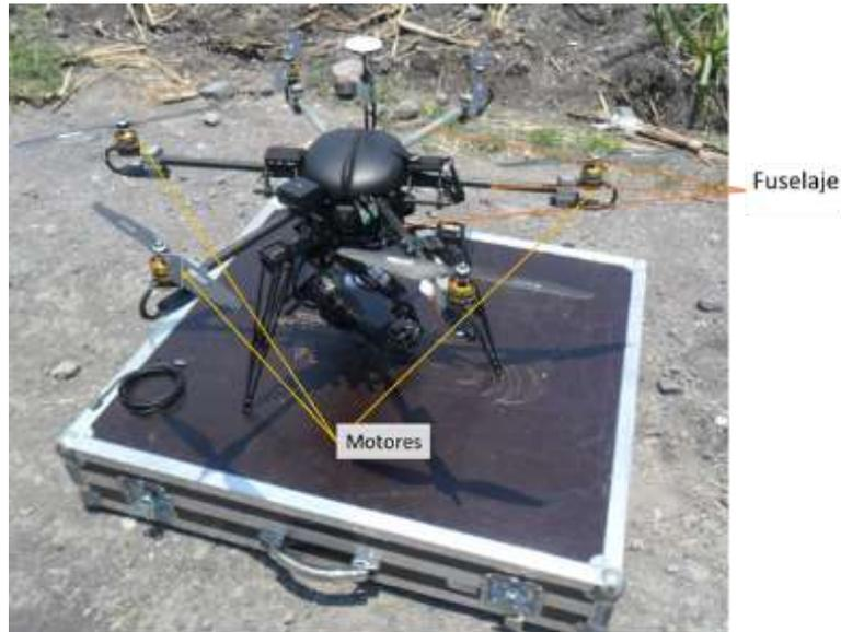
Figura 3.3 Fuselaje y motores de un hexacóptero
