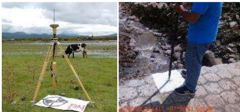
Figura 5.14 Levantamiento de puntos de control
