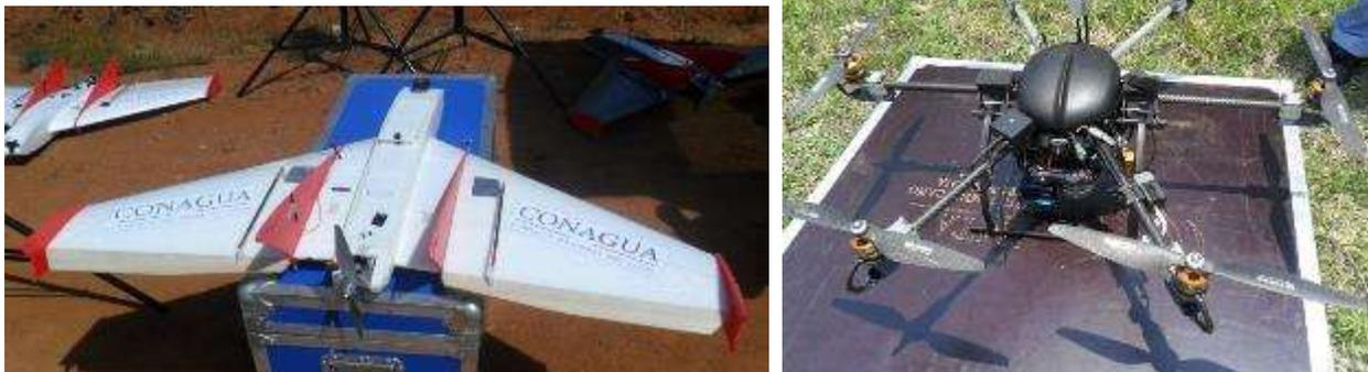
Figura 4.1 Los tipos de VANT más comunes. Ala fija (izquierda) y multirrotor (derecha)
