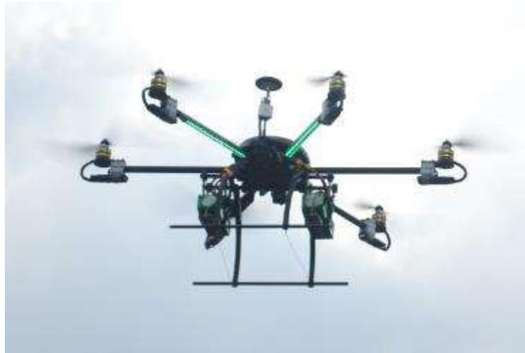
Figura 3.9 Dron tipo hexacóptero
