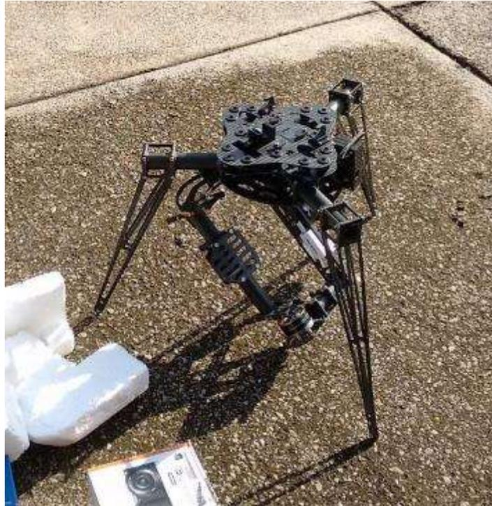
Figura E.12 Montura de 3 ejes
