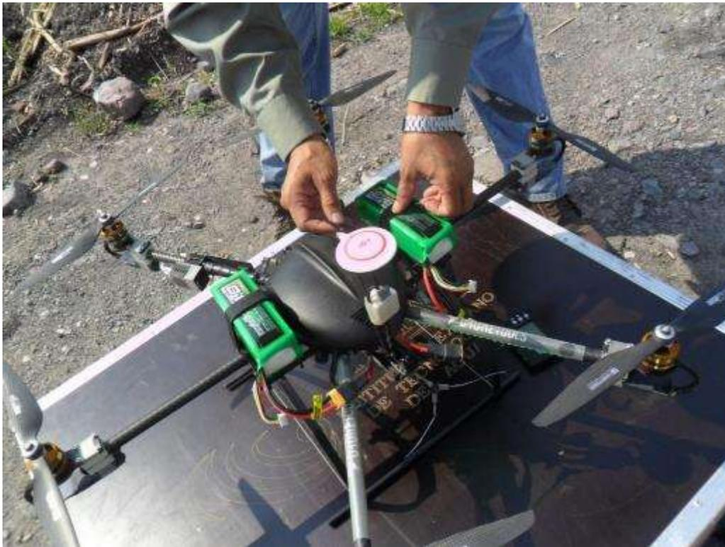
Figura 4.17 Encendido del dron con una batería
