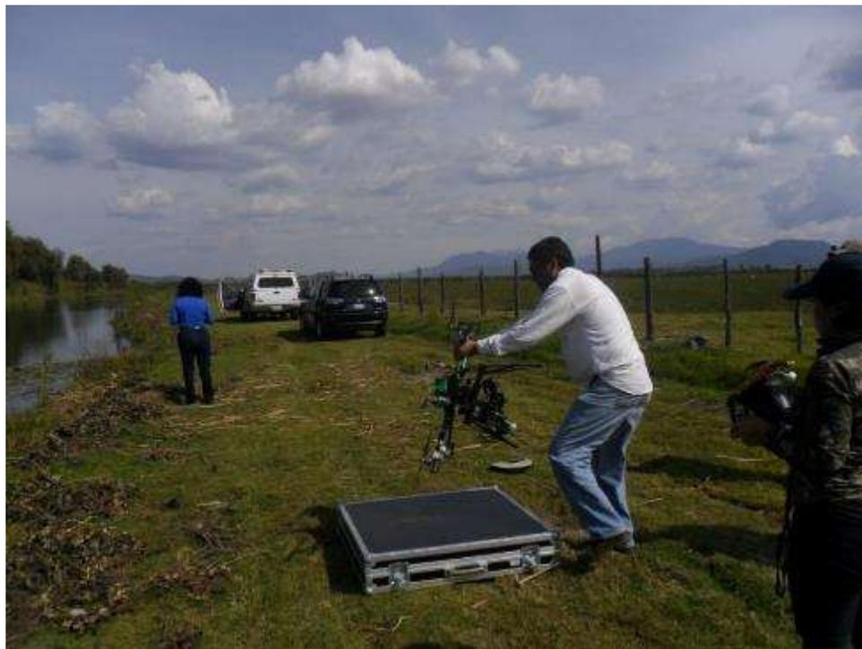
Figura 4.19 Calibrado de brújula, giro vertical respecto al eje del dron
