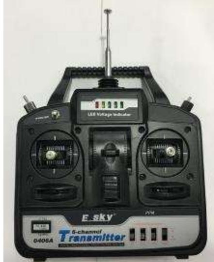
Figura B.13 Transmisor de radio de 6 canales
