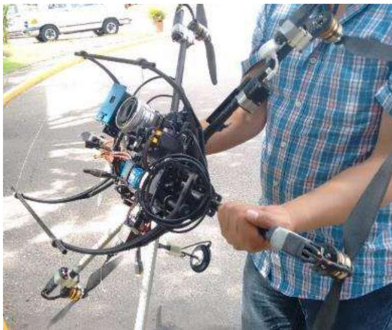
Figura E.9 Colocación de la montura de un eje al hexacóptero
