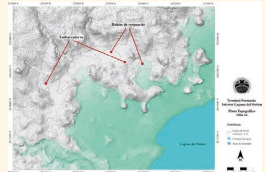
Proyección UTM Zona 15N, Datum Horizontal ITRF2008, referencia de cotas: nivel medio del mar, procedimiento de composición por Modelo Digital de Elevación, carta E15A85A1 de INEGI 2018 y levantamiento sobre terreno con Estación Total SOKKIA 6" laser, PiLaB 2017. Editado para este documento por Budar y Becerra.
