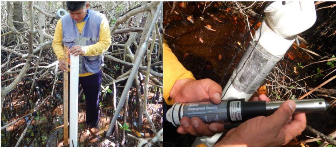
Fig.9 Colocación de medidores automáticos de presión en el sitio de referencia y degradado.
