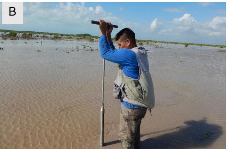
Obtención de núcleos de sedimento con dispositivo de A-PVC y B-metal
