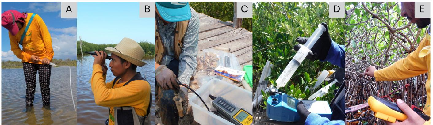
Medición de variables físicoquímicas del agua. A-Obtención de salinidad intersticial. B-Medición de salinidad con un refractómetro y C-usando un sensor multiparamétrico. D-Medición de potencial redox y pH con un potenciómetro de campo y E-Medición de redox con varillas de cobre, un voltímetro y un electrodo de platino.
