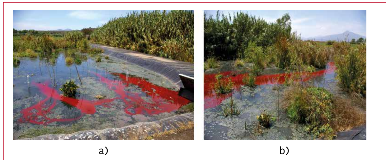
Ilustración 2.29 Flujos preferenciales mediante el uso de trazadores: a) Zona de entrada al humedal, mediante tubería perforada, b) flujo preferencial superficial sobre el lecho del humedal
