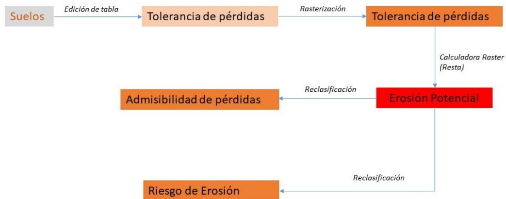
Figura 116. Diagrama de procesos para la determinación de Riesgo de erosión y Admisibilidad de pérdidas suelos.
