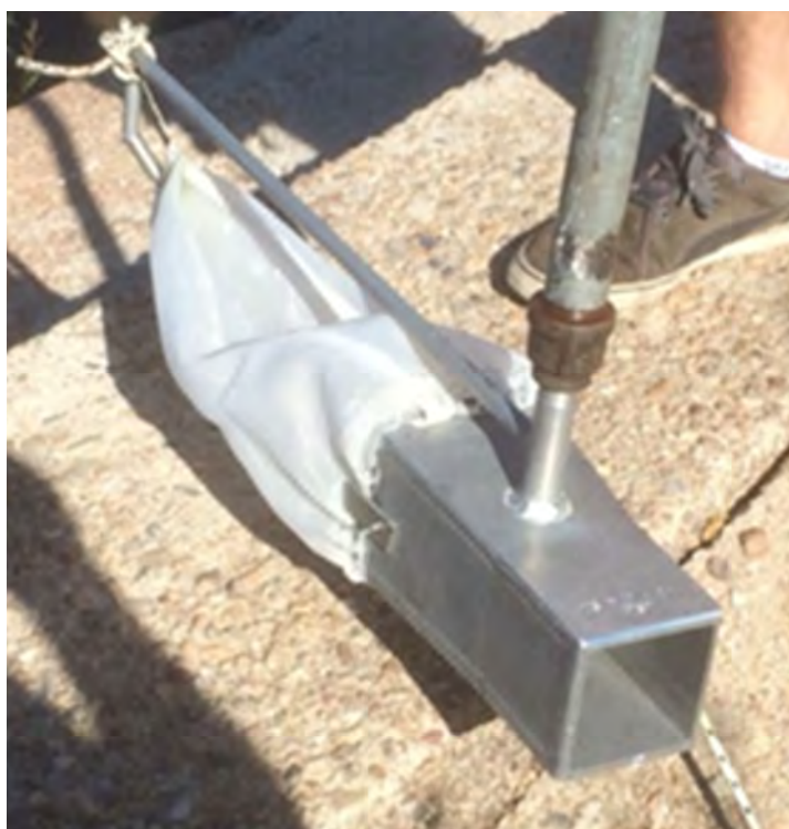
Figura 9-2. Muestreador de fondo tipo US-BL84, utilizado por el IMFIA para el transporte por fondo de cursos fluviales.
