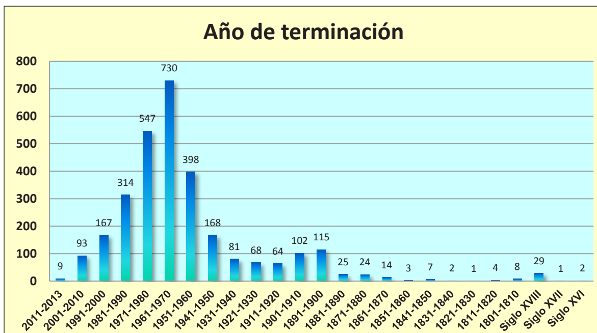
Figura 7-3. Periodo de construcción de las principales presas de México
