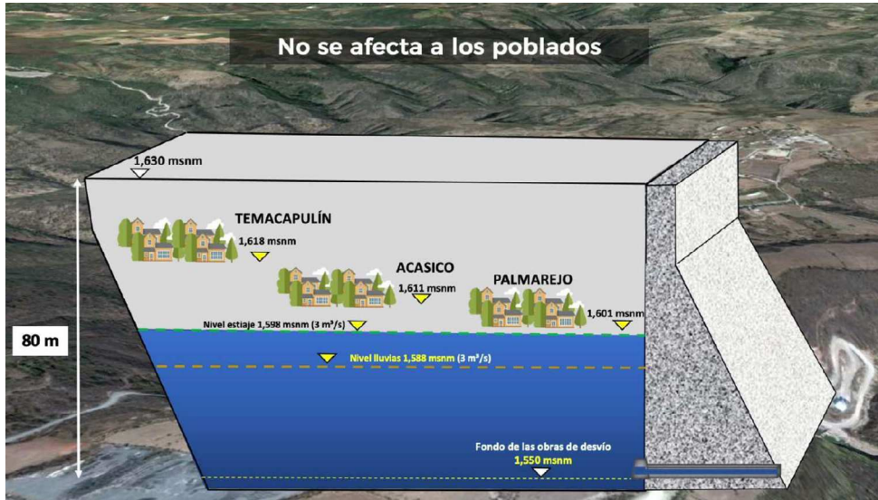
Figura 3. Perfil de la presa El Zapotillo. Ajuste a la cortina y capacidad del embalse a 50 m para evitar la inundación de Temacapulín, Acasico y Palmarejo.
