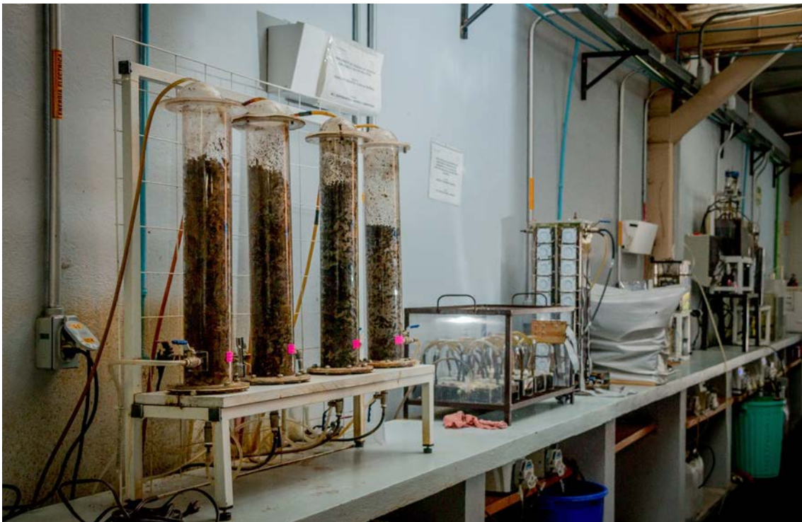
Biofiltro Laboratorio de experimentación del IMTA Planta piloto. © IMTA.
