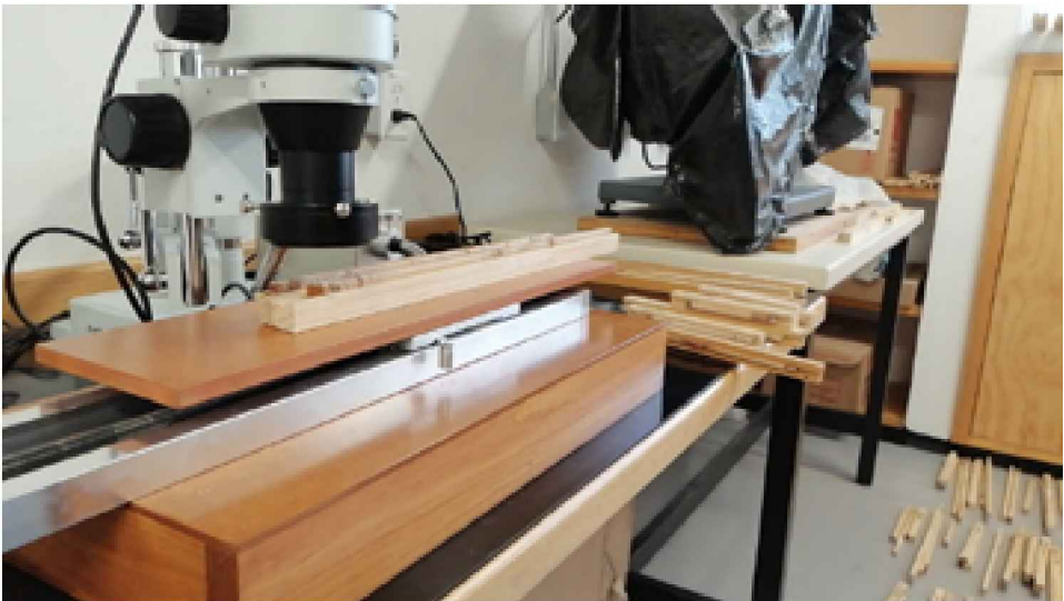
Figura 15. Medición del ancho del anillo de un árbol usando un sistema de medición Velmex a una resolución de 0.001 mm.
