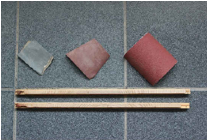
Figura 13. Núcleos procesados con papel de lija (tamaños de grano progresivos desde 80 hasta 1200 granos \text{cm}^{-2} ).
