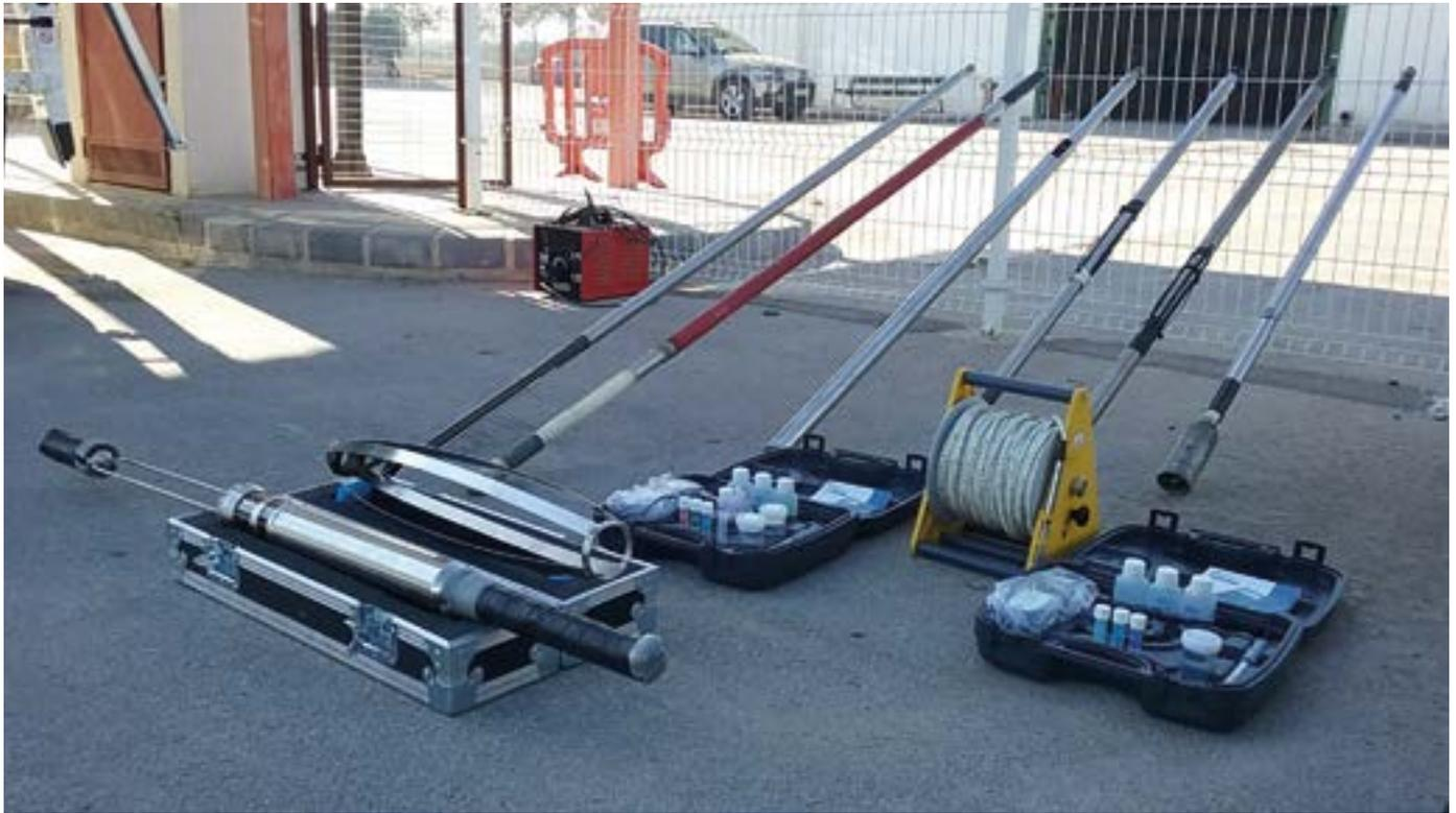
Diferentes sondas y cámara de video para sondeos. Fuente: AQUATEC.
