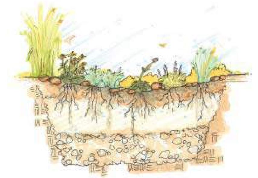
Figura 1.2 Jardín de lluvia. Consiste en una depresión en el terreno que utiliza vegetación y sustratos para limpiar y filtrar el agua de escorrentía pluvial antes de que se infiltre al suelo. Fuente: Disponible en: http://plantnj.com/blog/2013/03/19/rain-gardens-nj-creative-rain-garden-design-for-small-yards/ Acceso en mayo, 2015.
