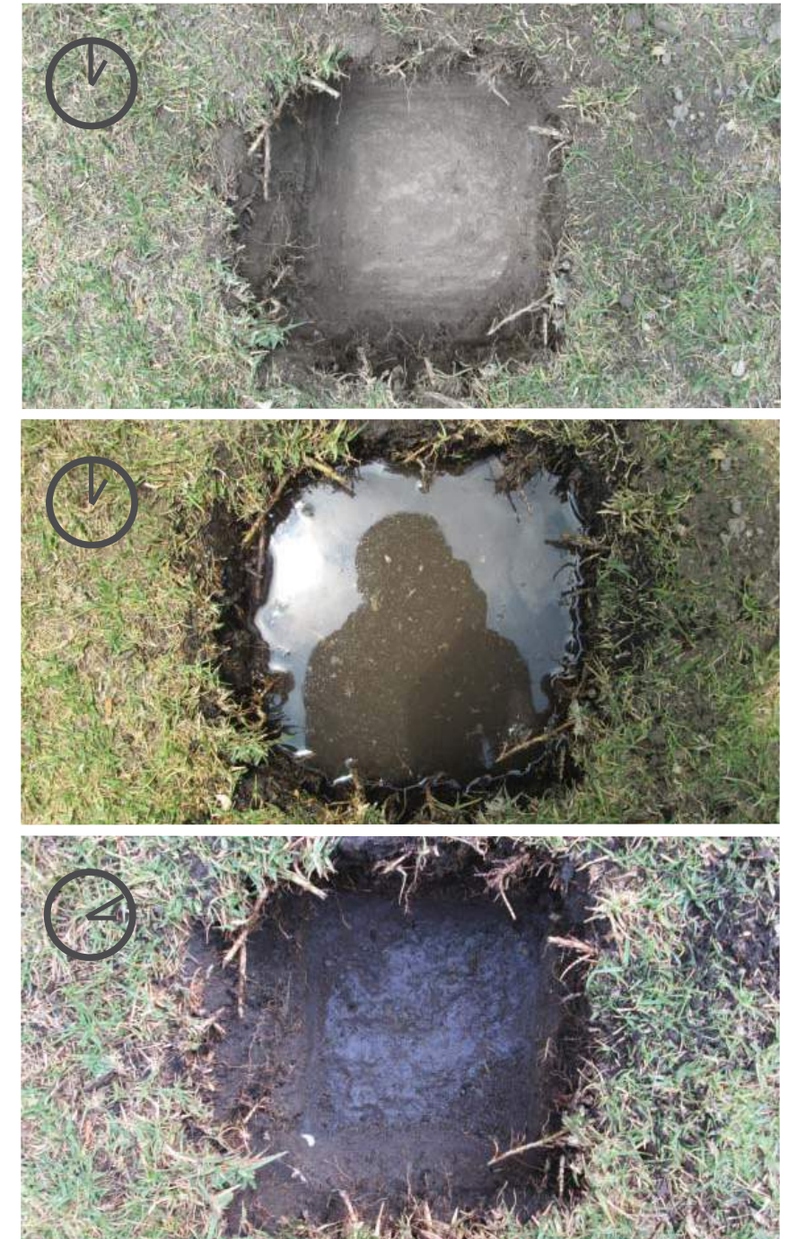
Figura 3.4 Prueba de infiltración básica (de arriba hacia abajo) 13:00 (previo inundación), 13:00 (inicio de inundación) y 15:10 (término de inundación). Fuente: Casandra Badillo, 2014.
