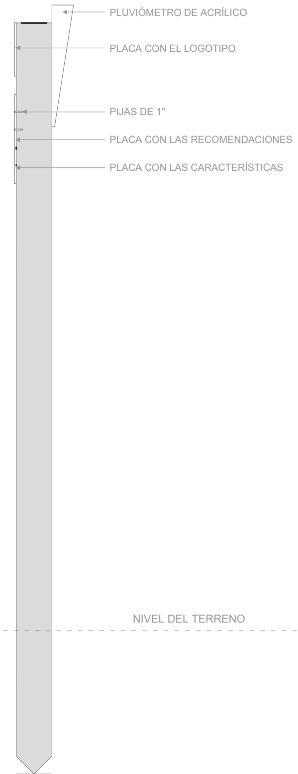
24 DETALLE CONSTRUCTIVO Alzado lateral- Estela informativa ESC 1:10
