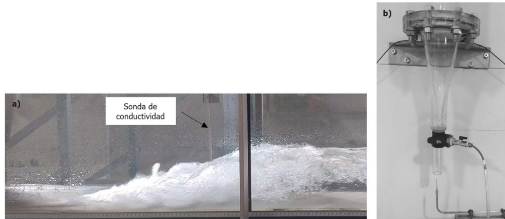
Figura 4 | Sonda de conductividad. a) Medición de fracción de aire en el resalto b) Banco de calibración de la sonda.
