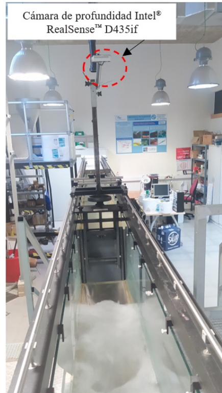
Figura 1 | Instalación experimental vista desde aguas abajo del resalto.
