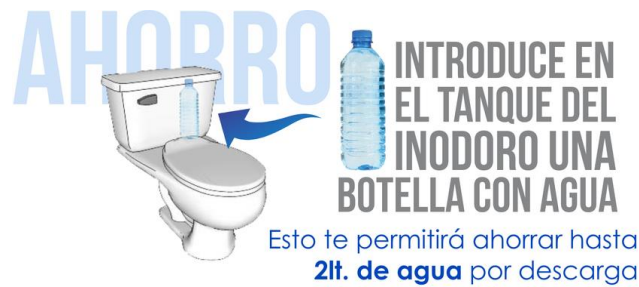
Figura 4.2 Disminución de volumen de agua en caja de WC de alto consumo. Fuente: Sedapal (2025)
