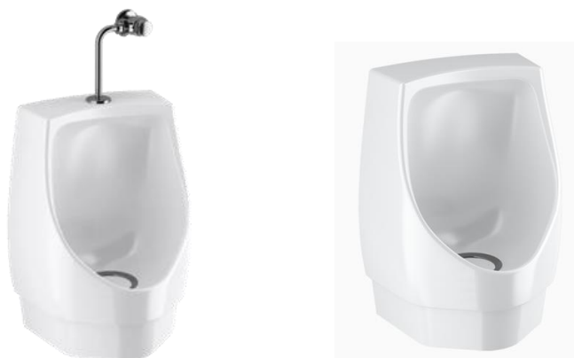
Figura 4.8 Mingitorios híbridos con uso de agua sólo para lavado del mueble; con línea de agua para lavado para reemplazar usar toma del mingitorio tradicional (izq.) y con líneas internas para nuevas instalaciones (der.). Fuente: SLOAN REPAIR.COM (2019)
