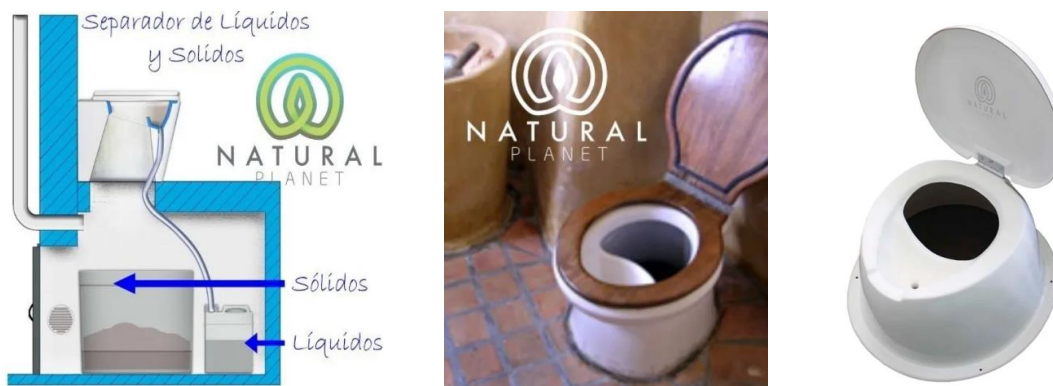
Figura 4.9 WC seco por desviación de orina: esquema (izq.), caso en Tepoztlán, Morelos (centro); evolución (der.). Fuente: Tilley et al., 2018. Fuente: Naturalplanet, (2025)
