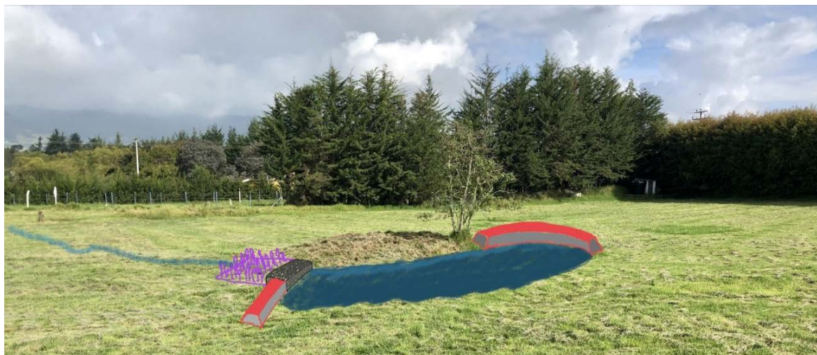
Figura 8: Biofiltro secuencial. En la parte izquierda, el agua pasa por un filtro biogeoquímico compuesto por piedra caliza y dolomita: por la capacidad de fijar biopelículas microorganismos. con una relación de 10 (caliza) a 1 (dolomita)
