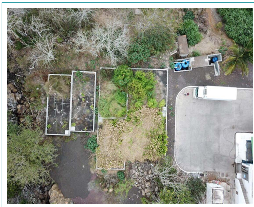
Figura 7. Foto aérea del Humedal Artificial para tratamiento de aguas residuales provenientes de la planta de eviscerado de pescado en Puerto Ayora.
