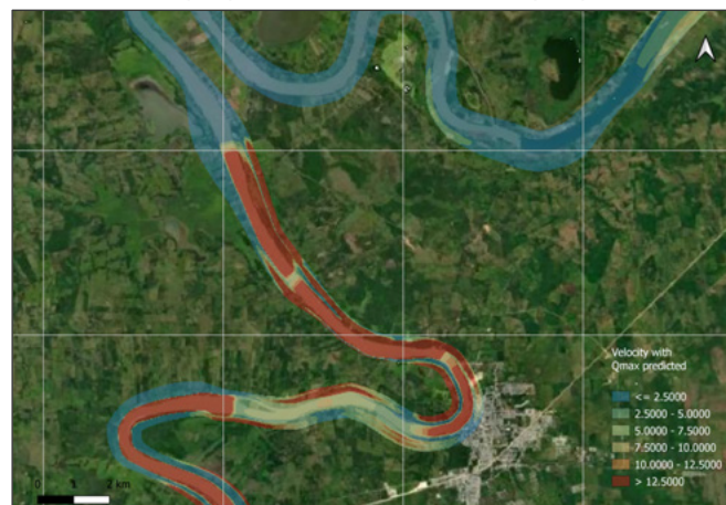
Figura 4 (a) Mapa de profundidad y (b) velocidad para estudio de inundaciones en el Río Usumacinta proyectado hasta 2050.
