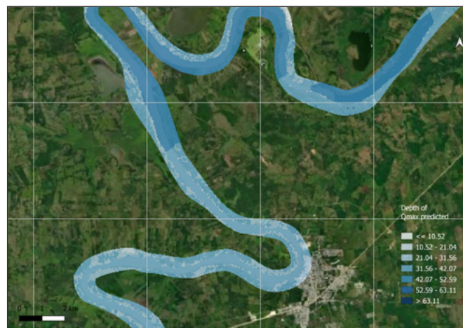
Figura 4 (a) Mapa de profundidad y (b) velocidad para estudio de inundaciones en el Río Usumacinta proyectado hasta 2050.
