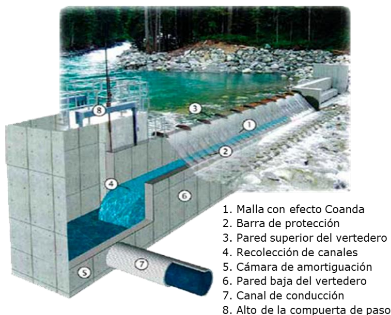
Figura 9.21 Captación con reja autolimpiante tipo Coanda. Adaptado de (CBS ING S.A. Ingeniería, Coanda, 2015)
